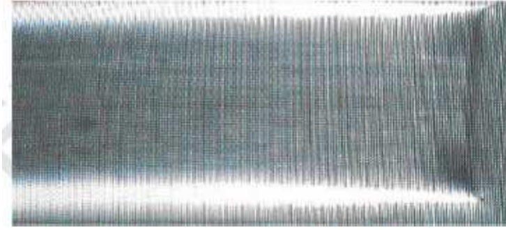
Şekil 2.20. “Cut-Back” ölçümünde çıkış gücü P_{\text{giriş}} değerinin elde edildiği optik fiber çıkış ucunun uç düzgünlüğü.
