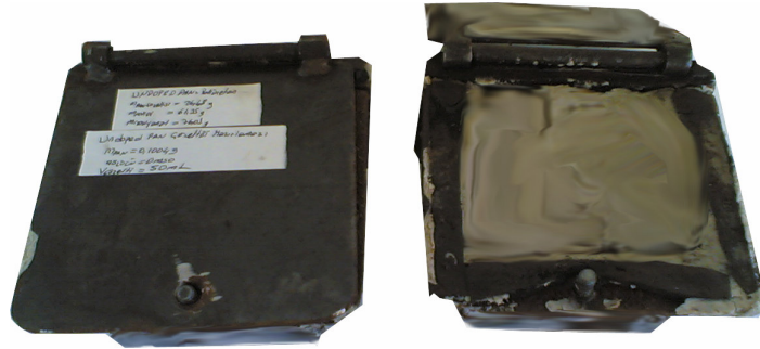
Şekil 3.1. Hazırlanmış olan poliüretan kalıbı
