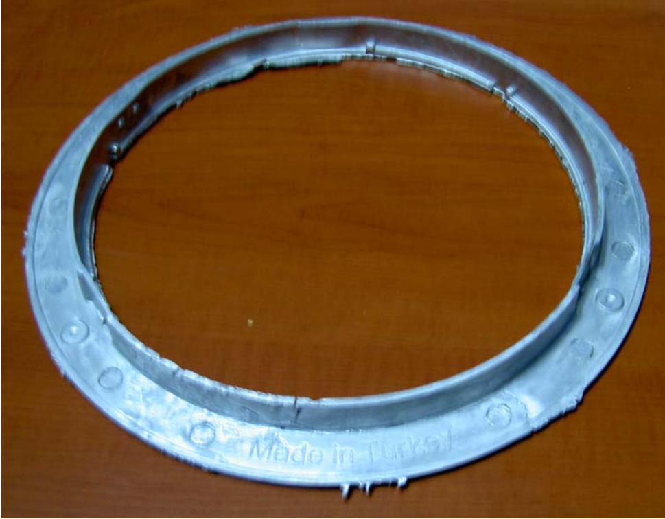
Şekil 4-5 Flanş İçin Elverişsiz Yolluklu Kalıpta Elde Edilen İş Parçaları
