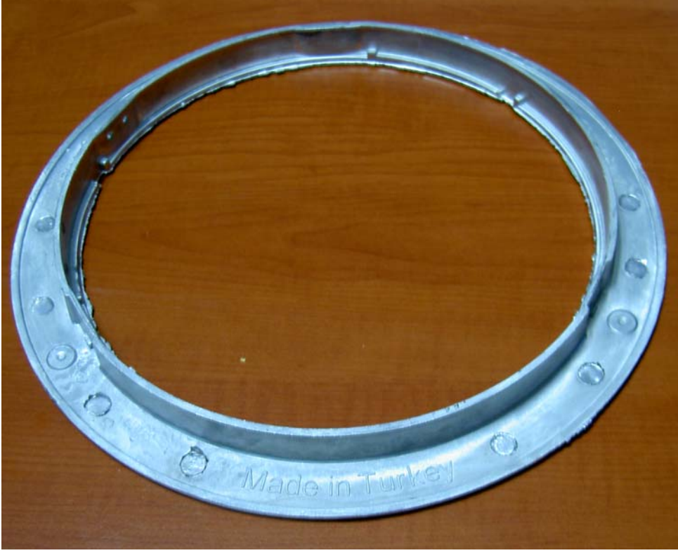
Şekil 6 Flanş İçin Elverişli Yolluklu Kalıpta Elde Edilen İş Parçası
