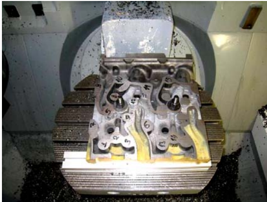
Şekil 4.2. CNC tezgaha bağlanmış CGI iş parçası
