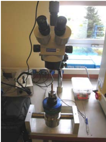
Şekil 4.4. Deney sonrası matkaplardaki aşınma fotoğraflarının çekilmesi işlemi.
