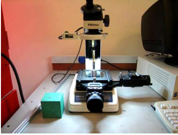
Şekil 4.3. Deney sonrası matkaptaki aşınmaların ölçümü.
