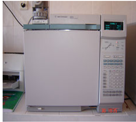
Agilent 7683 injector (solda), fırın ve dedektör kısmı (sağda)
