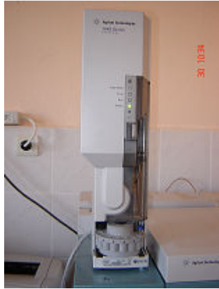
Agilent 7683 injector (solda), fırın ve dedektör kısmı (sağda)
