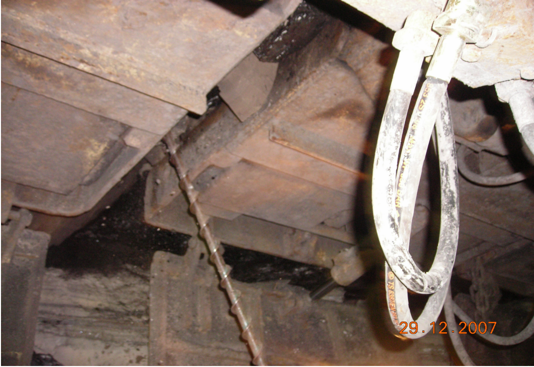
Şekil 5.4. Arka kömürü alınmasında tavandan numune alınması
