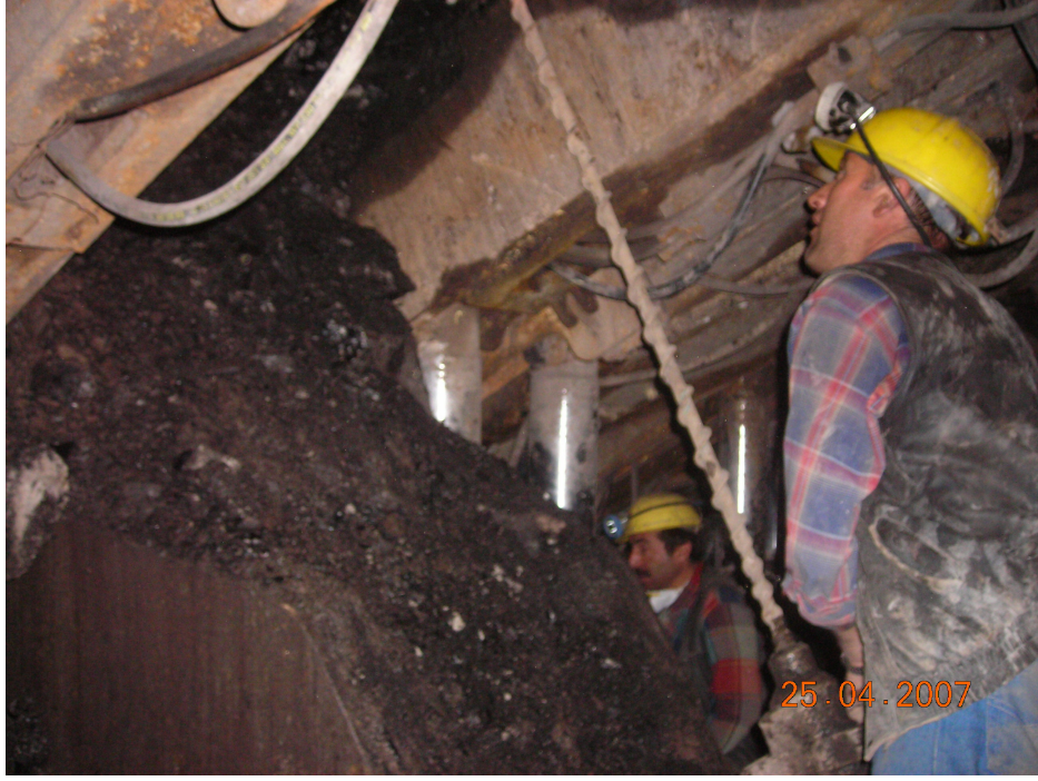
Şekil 5.2. Tahkimat penceresi içerisinde delik delme işlemi
