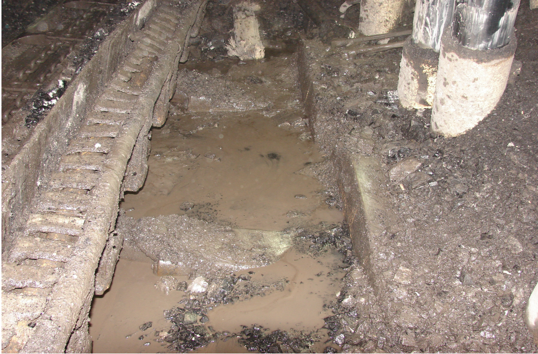
Şekil 4.9. Ayak zincirli oluğunun ötelenmesi
