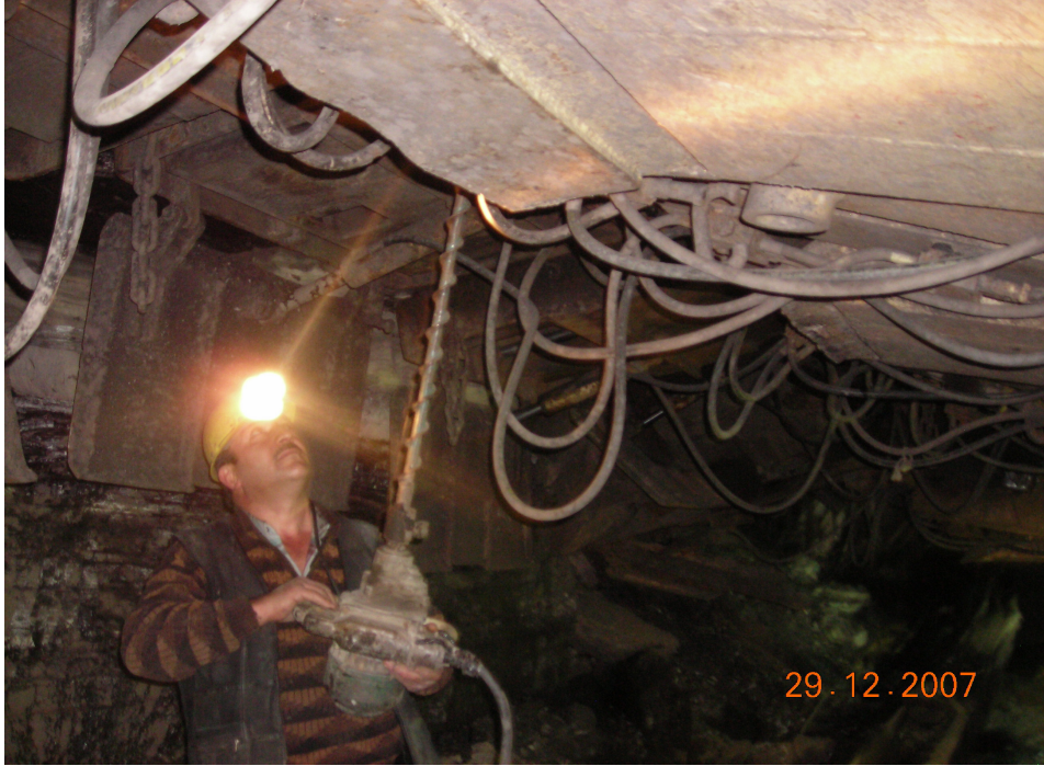
Şekil 5.3. Tahkimat arasından delik delme işlemi
