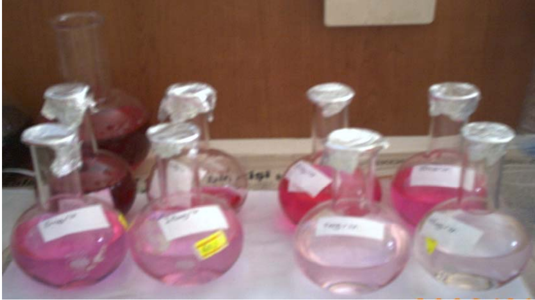
Şekil 3.1. Kalibrasyon eğrisi çıkarmak için farklı konsantrasyonda hazırlanan boya çözeltileri
