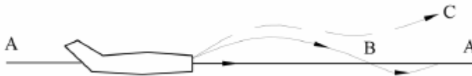
Şekil 2.7. A-A doğru yolu boyunca yatay düzlemde uçan dengelenmiş durumunun stabilite analizinin çizimi
