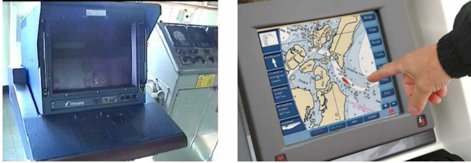
Şekil 12.1 Köprüüstünde ECDIS cihazının görüntüsü.
