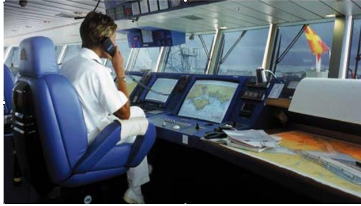
Şekil 12.2 Köprüüstünde ECDIS cihazının konsol görüntüsü.
