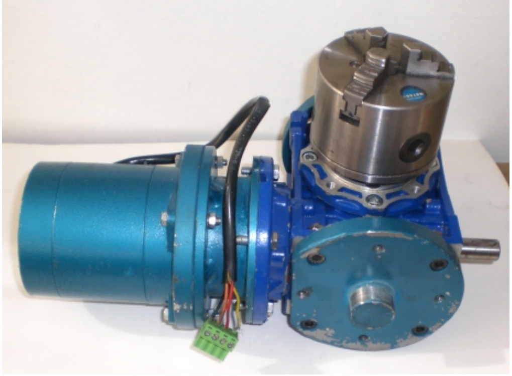
Şekil 4.2 Step motoru, redüktör ve aynanın toplanmış hali
