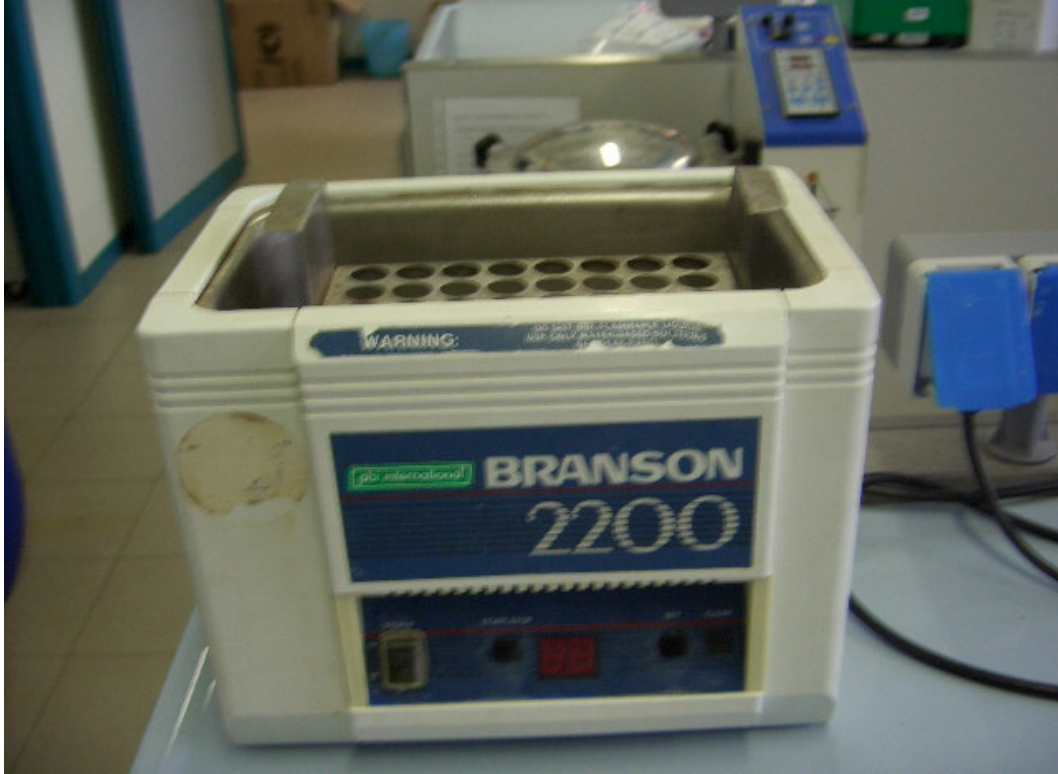
Şekil 3.7. Ekstraksiyon verimliliğini artırmak için bakteri sayımında kullanılan sonikatör cihazı
