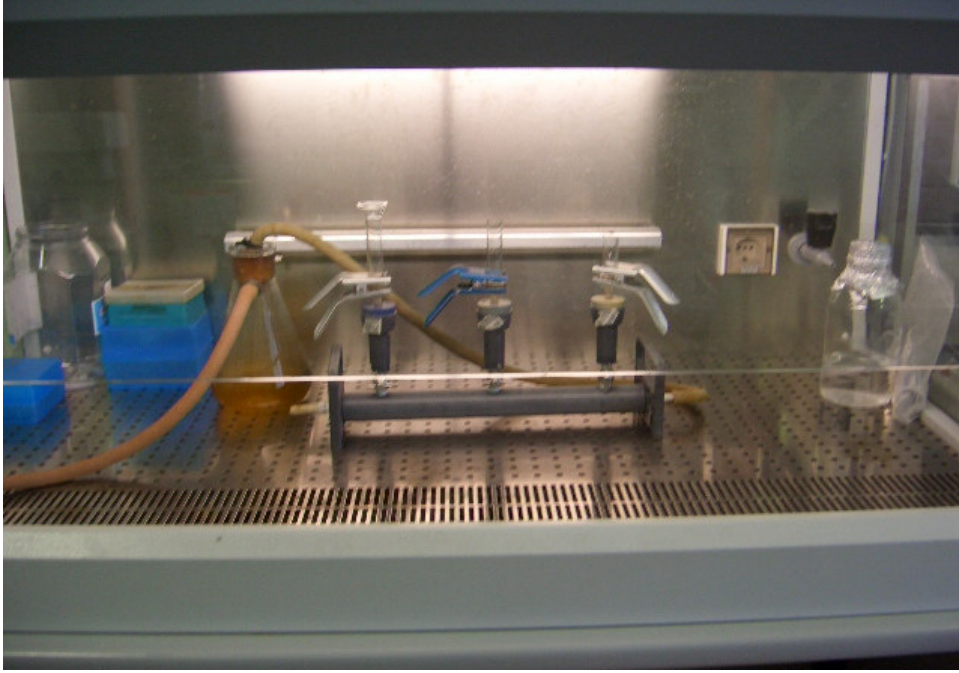
Şekil 3.4. Bakteri sayımından önce örneklerin filtrelenmesinde kullanılan filtre cihazı
