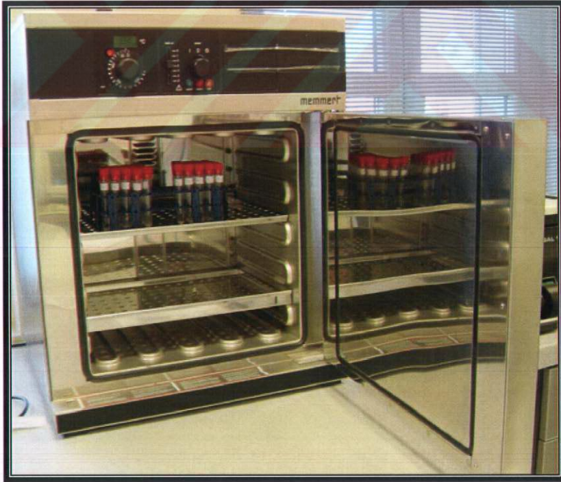
Resim 13. Örneklerin deney süresince saklandığı 37°C'lik etüv.
