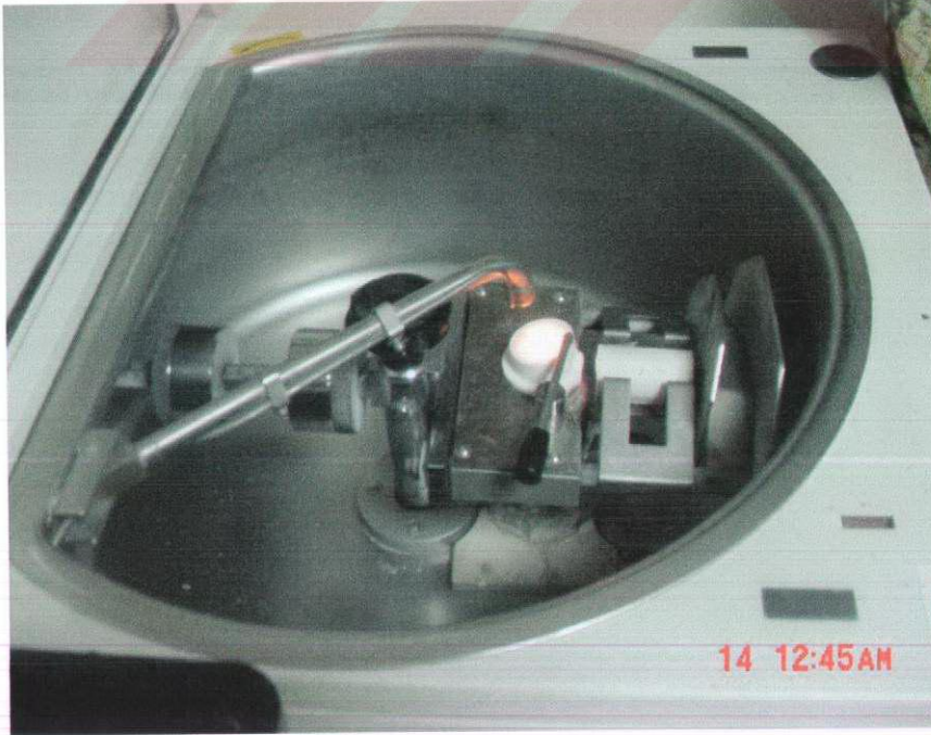
Resim 3.13 : Çalışmamızda dökümlerin yapıldığı santrifüjlü döküm makinesi
