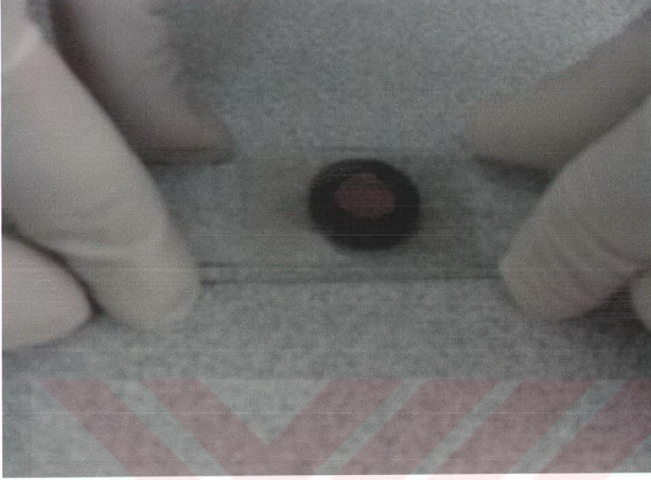
Resim 3.4: Deney örneklerinin mikroskop camı arasında hazırlanışı
