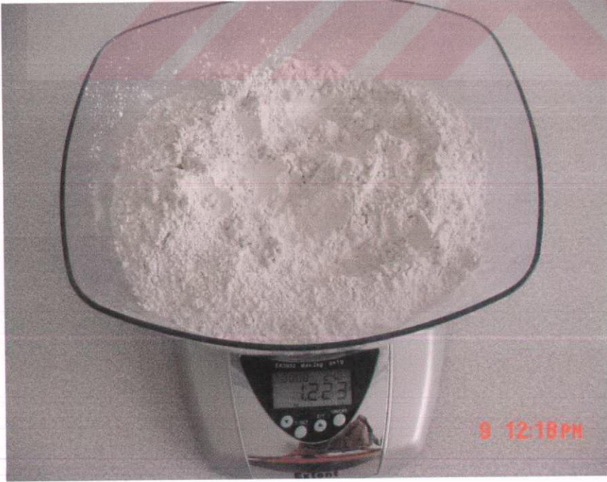
Resim 3.11: Revetmana zeolit ilave edilirken kullanılan hassas terazi
