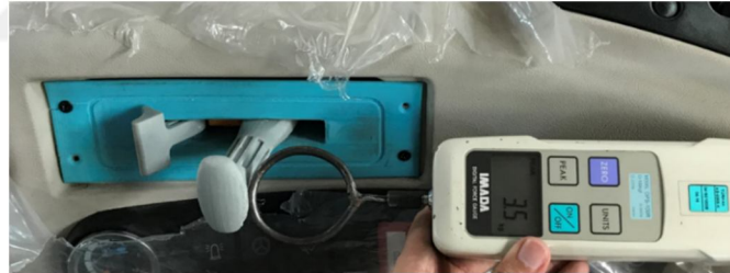
Şekil 5.2. Birinci alternatif kol mekanizmasının kuvvet ölçümü
