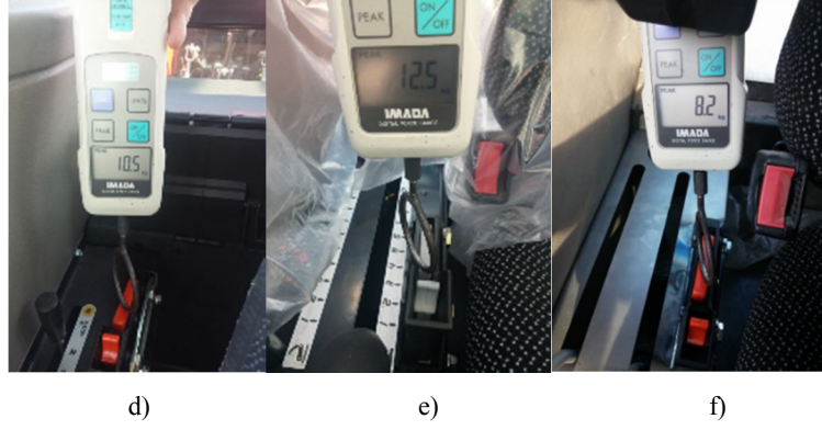
Şekil 5.1. Mevcut teknolift mandalların kuvvet ölçümleri (DEVAMI)
