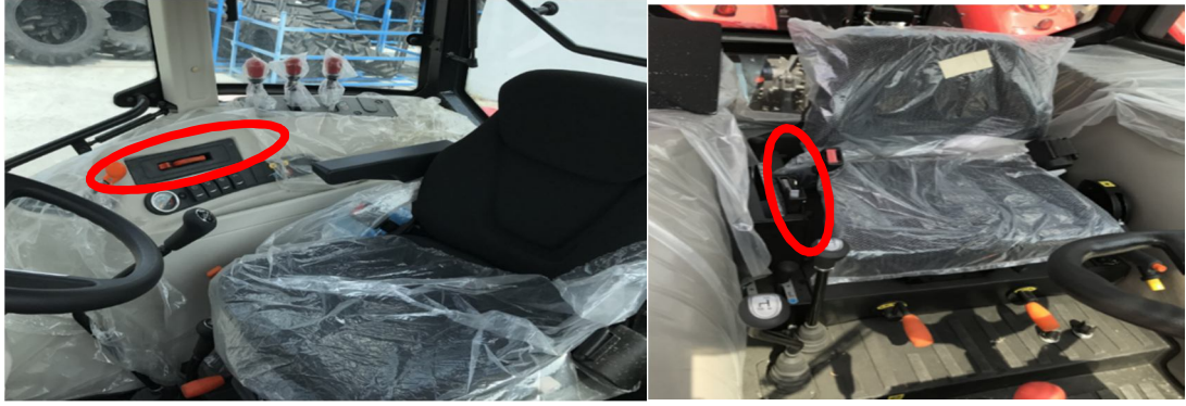
a) Sağ trim üzerinde konumlu teknolift mandalı b) Koltuk yanında konumlandırılan teknolift mandalı
