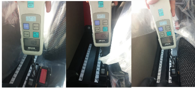
Şekil 5.1. Mevcut teknolift mandalların kuvvet ölçümleri
