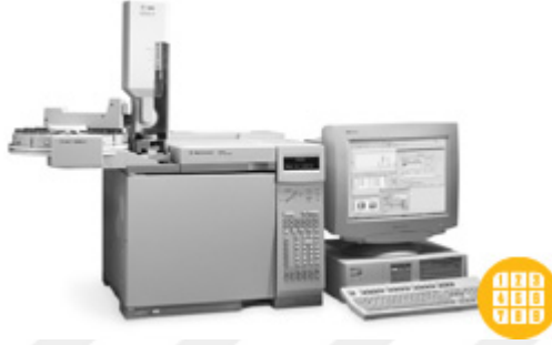
Şekil 3. 3. Yağ asit kompozisyonlarının analiz edildiği GC cihazı
