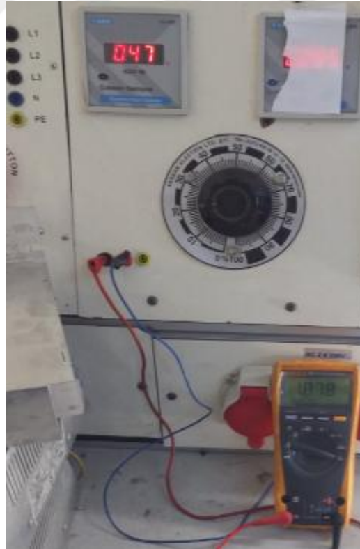
Şekil 4.12. Tam yük testinde ampermetrenin ölçtüğü yük akımının değeri ve transformatörün alçak gerilim besleme voltajı
