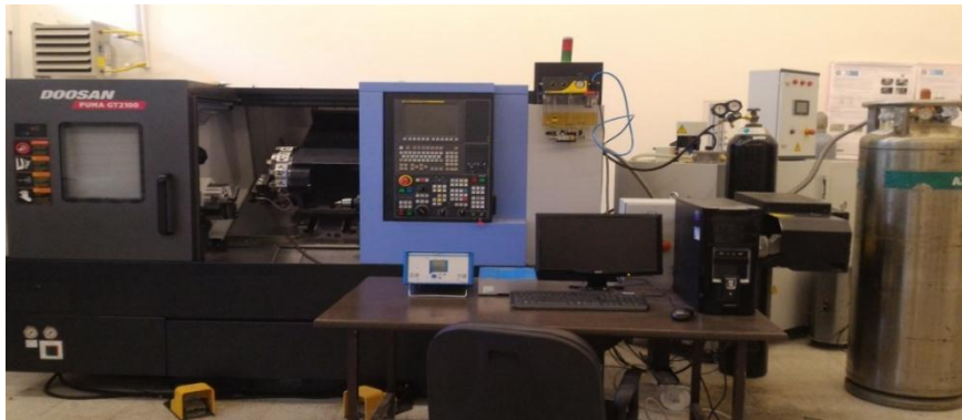
Şekil 2.5 Doosan Puma GT2100 CNC torna tezgahı.
