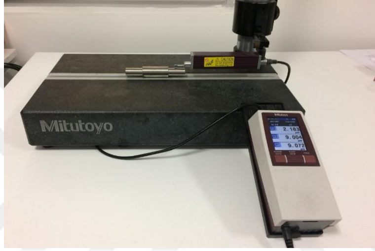
Şekil 2.9. Deneylerde kullanılan yüzey pürüzlülüğü ölçüm cihazı
