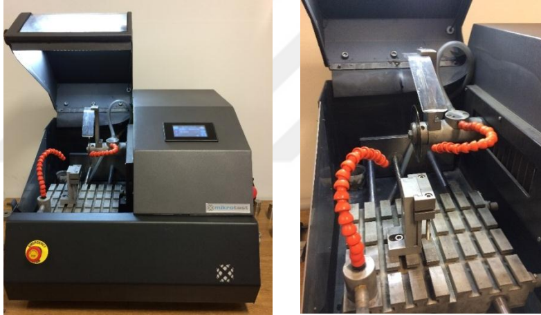
Şekil 2.13. İşlenen Ti-5553 alaşım malzemelerden metalografik numune hazırlama aşamasında kullanılan hassas kesme cihazı
