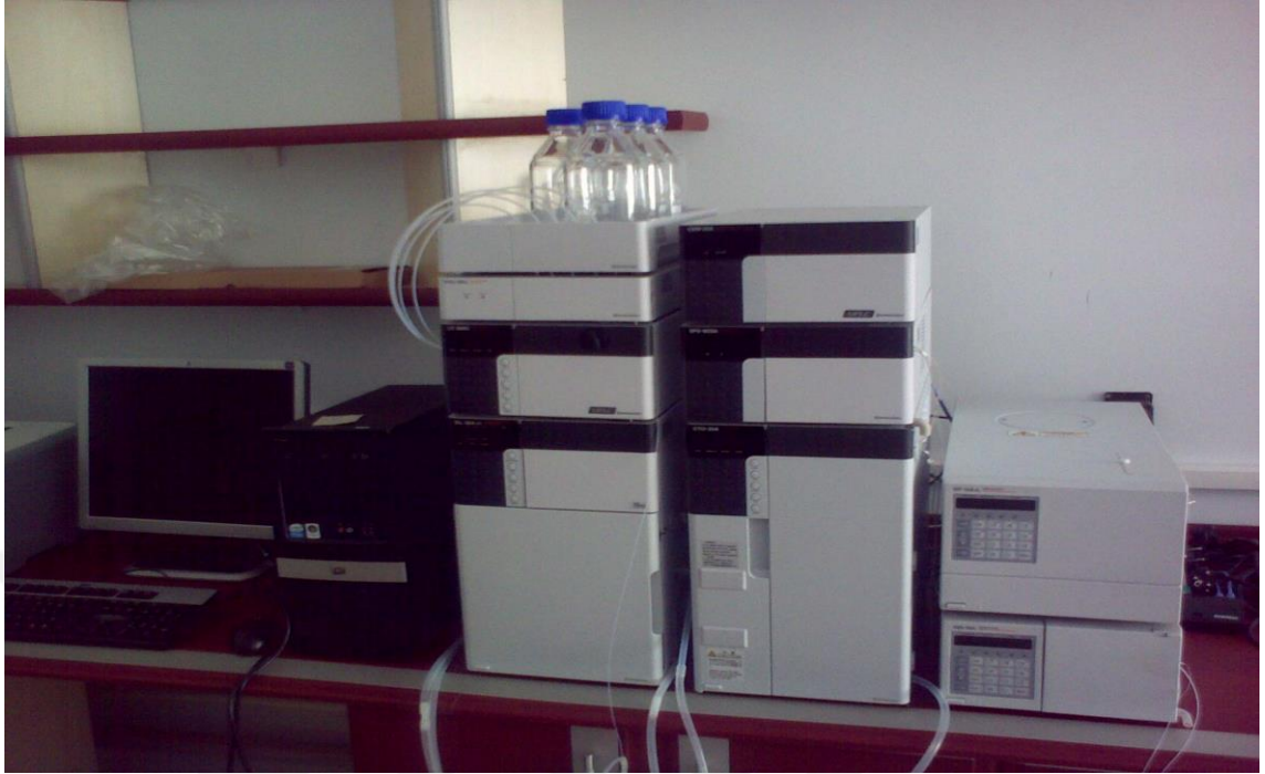
Şekil 3.7. Peynir örneklerinin peptit profillerinin belirlenmesinde kullanılan HPLC cihazı
