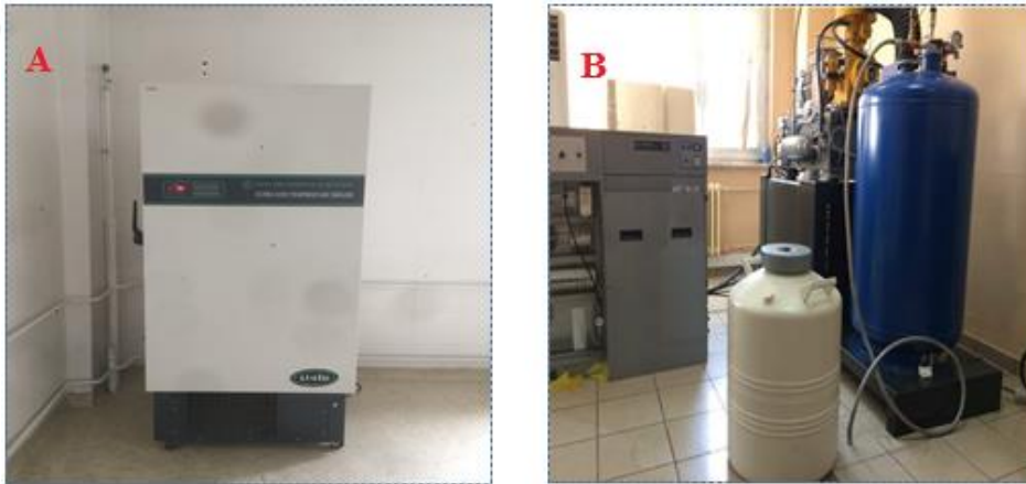
Şekil 2.11. (a) -80^{\circ}\text{C} dondurucu ve (b) -196^{\circ}\text{C} azot tankı
