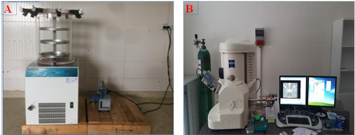
Şekil 2.8. a)Liyofilizatör Cihazı, b) Taramalı Elektron Mikroskobu (SEM)
