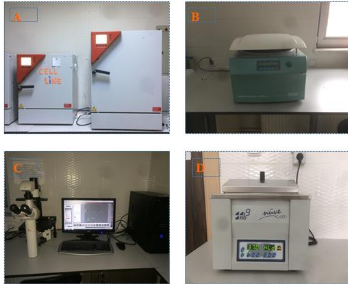
Şekil 2.6. HGF-1 hücre hattı kültüründe kullanılan cihazlar; (a) inkübatör, (b) santrifüj, (c) invert mikroskop ve (d) su banyosu.
