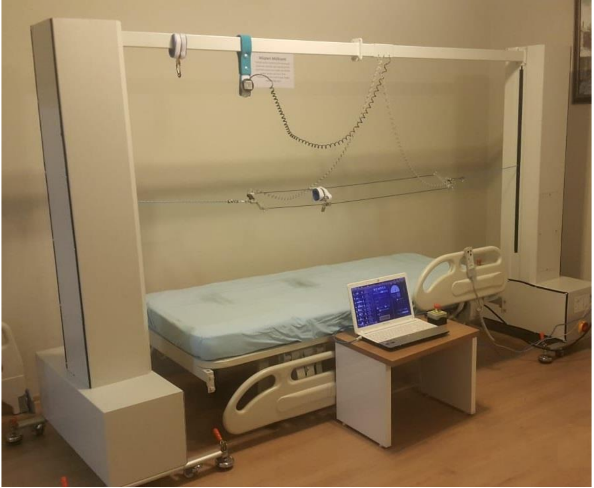
Şekil 8. 1 Kontrolcü stabilite ve performans değerlendirme deneyi kurulumu
