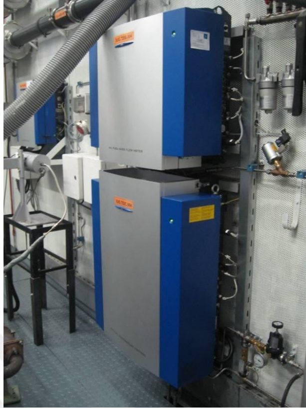
Şekil 3. 4 Deneylerde kullanılmış olan AVL 735S yakıt sarfiyatı ölçüm ve AVL 753C yakıt sıcaklığı kontrol cihazı kombinasyonu.
