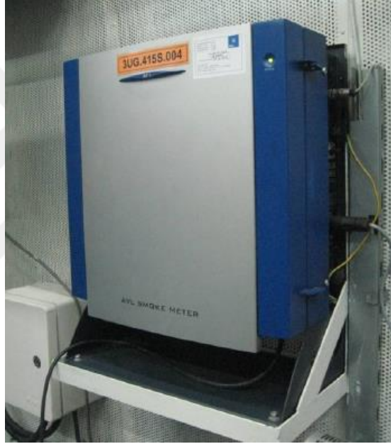
Şekil 3. 5 Deneylerde kullanılmış olan AVL 415S is ölçüm cihazı
