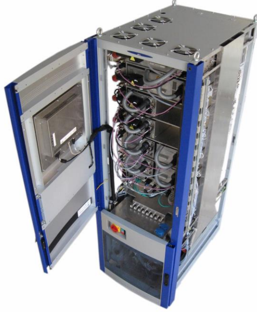
Şekil 3. 6 Deneşlerde kullanılmıř olan AVL i60 egzoz emisyon ölçüm cihazı
