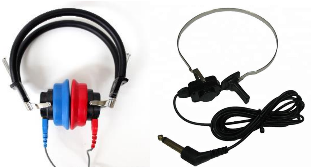
Şekil 7. Supra -aural Hava İletim Kulaklığı TDH-39 (Solda) ve RadioEar B71W Kemik İletim Vibratörü(Sağda)
