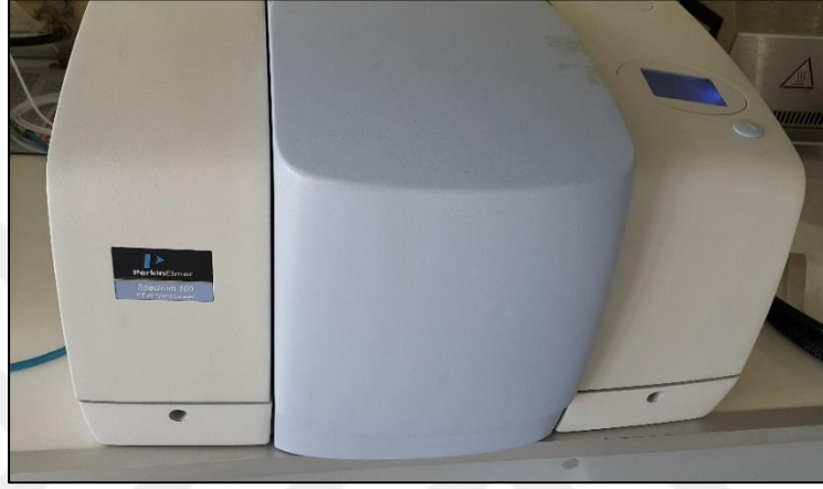
Şekil 5.21 Fourier dönüşümlü kızılötesi (FTIR) spektroskopisi cihazı
