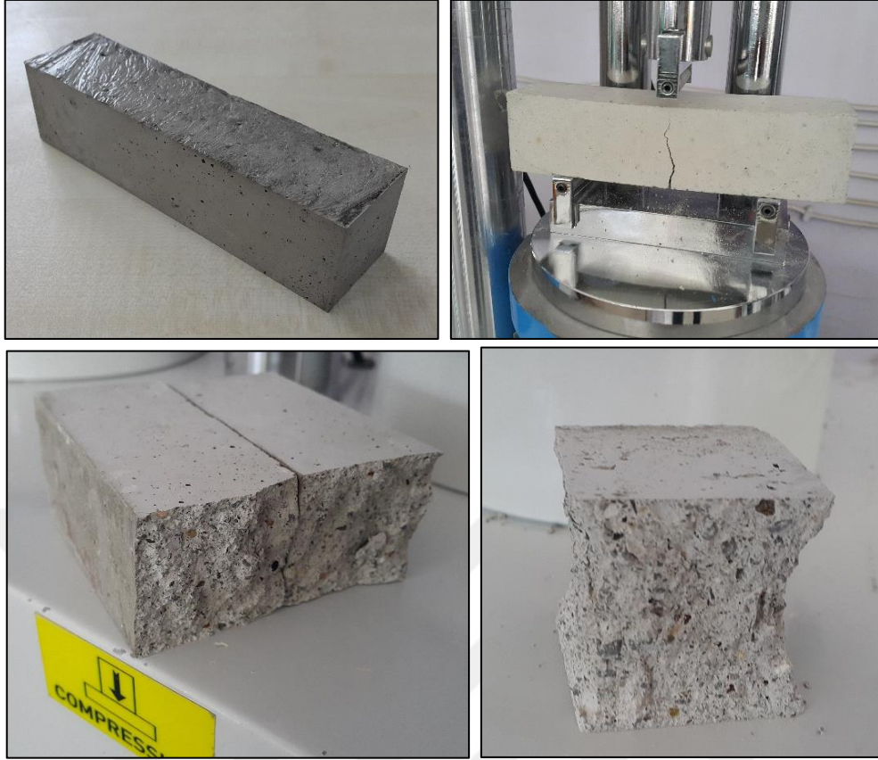
Şekil 6.57 Alkalilerle aktive edilmiş pomza içeren hibrit harçların eğilme ve basınç dayanımı deneyleri
