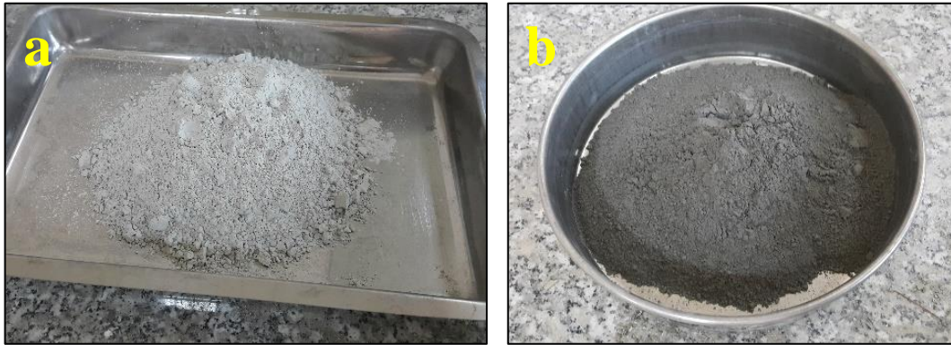
Şekil 5.1 a) Öğütülmüş pomza ve b) Portland çimentosu
