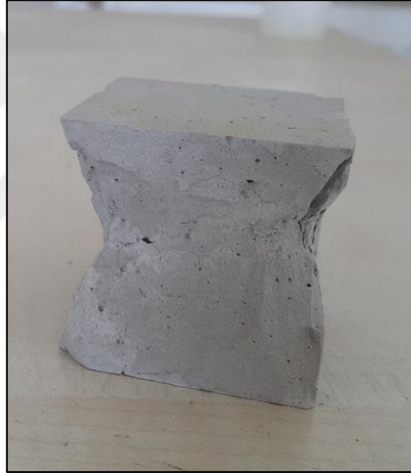
Şekil 6.17 Alkalilerle aktive edilmiş pomza içeren küp hamur numunenin kırılma biçimi
