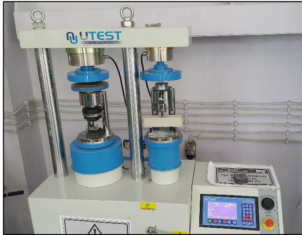
Şekil 5.17 40 \times 40 \times 160 mm harç numuneler için eğilme ve basınç dayanımı deneyi aleti
