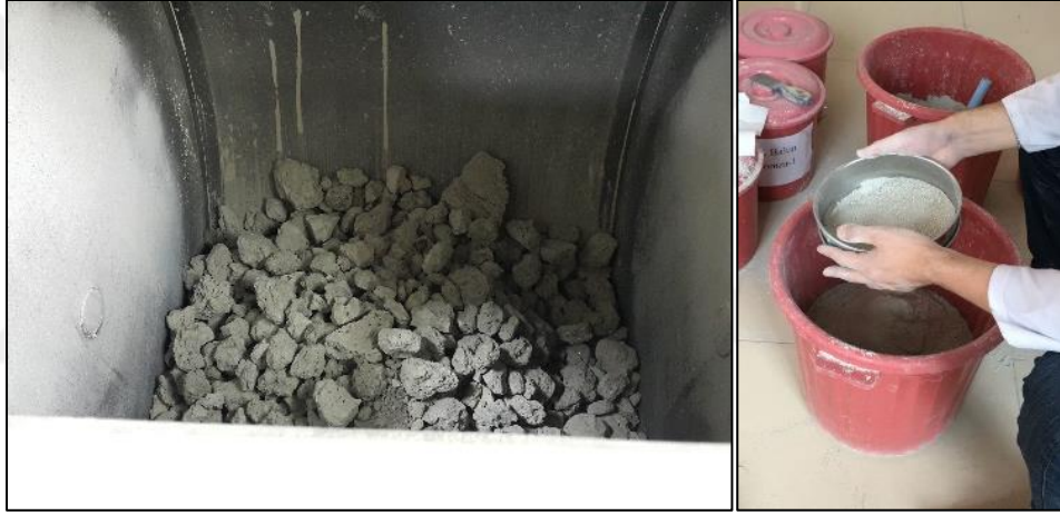
Şekil 5.8 Pomzanın öğütülüp elenmesi işlemi
