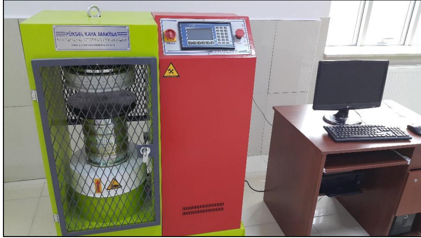
Şekil 5.16 Hamur numuneler için kullanılan basınç dayanımı test cihazı
