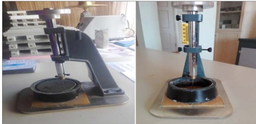
Şekil 3.9. Priz süresinin belirlenmesinde kullanılan Vikat cihazı.
