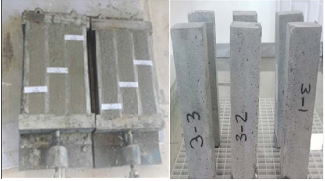
Şekil 3.13. Prizma kalıpları ve üretilen numuneler
