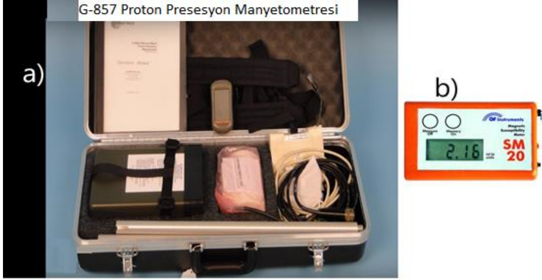
Şekil 4.3. Arazide kullanılan aletler a) Geometrics G-857 Proton manyetometre, b) GF Instr. SM-20 Süsseptibilite ölçer.
