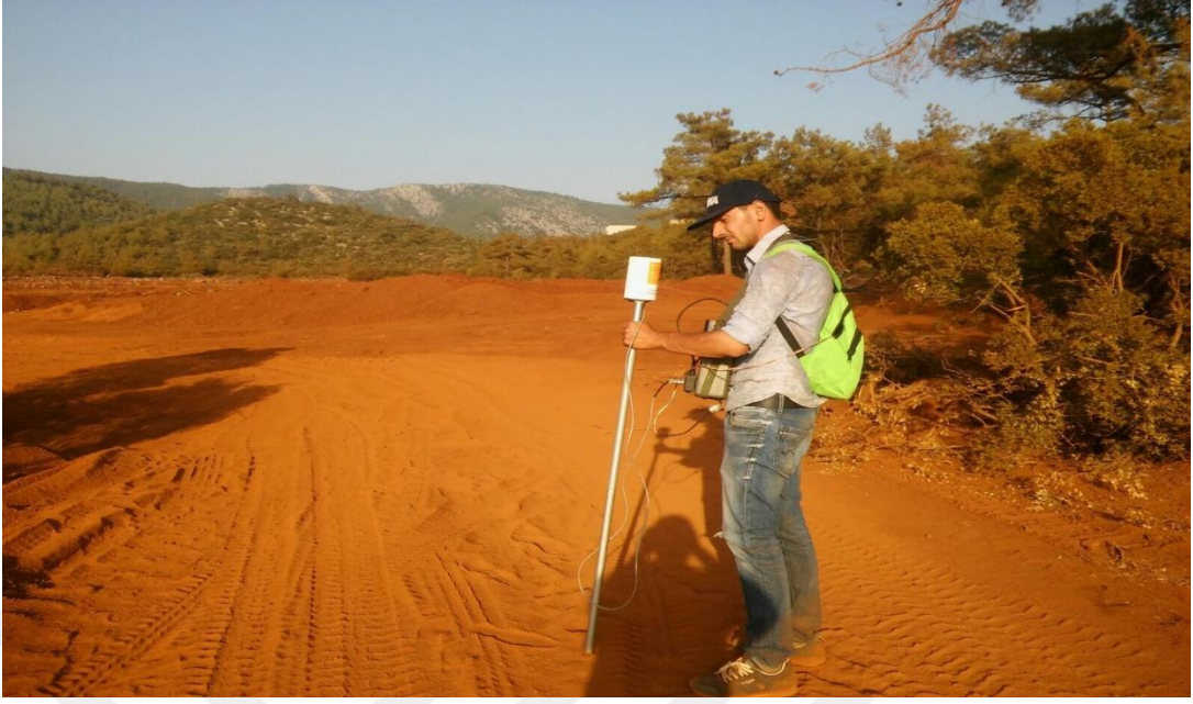
Şekil 4.1. Çalışmanın yapıldığı araziden bir görünüm ve kullanılan proton presesyon manyetometre ölçüm cihazı.
