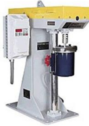
Şekil 3.2. Hammaddelerin öğütülmesi ve öğütülmüş hammaddelerin homojen olarak karışımını sağlamak amacı ile kullanılan Union Process marka atritör cihazı
