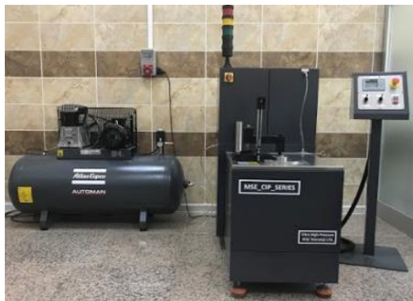
Şekil 3.4. Numunelerin nihai preslemesinde kullanılan Ultra High Pressure MSE CIP Series marka soğuk izostatik pres
