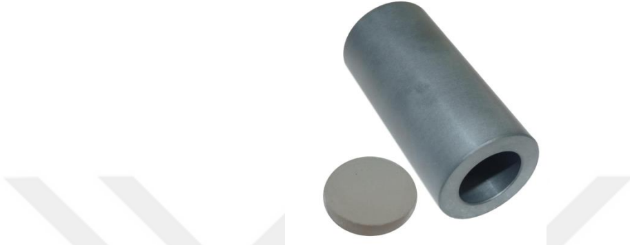
Şekil 3.5. Presleme esnasında kullanılan kalıp ve preslenmiş numune
