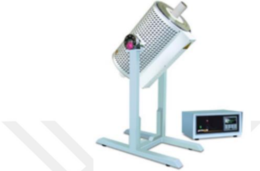
Şekil 3.7. Sinterleme aşamasında kullanılan 1500°C'lik Protherm marka tüp fırın
