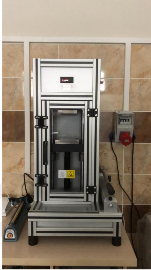
Şekil 3.3. Numunelerin ön preslemesinde kullanılan 150 mm piston strok mesafesine sahip 5 tonluk MSE marka manuel pres
