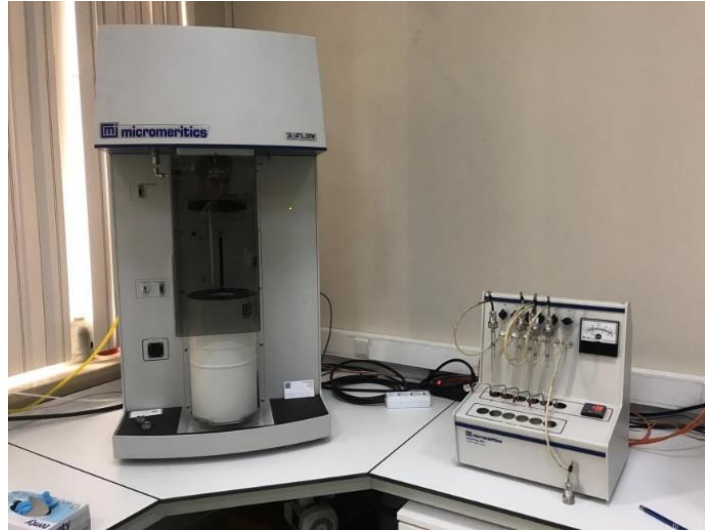
Şekil 3.13. Numunelerin BET analizlerinin yapıldığı Micromeritics 3 flex 3 portlu BET yüzey alanı ve mikro gözenek boyutu ölçüm cihazı
