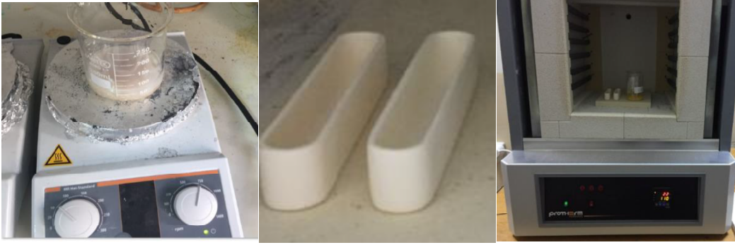
Şekil 3.7. Manyetik karıştırıcı, alümina kroze, kül fırın
