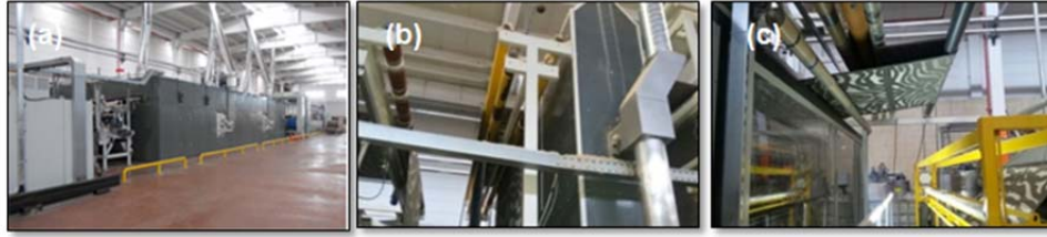
Şekil 3.5. (a)Sellers tek tamburlu apre makinesi görünümü (b) halının dikey buharlamaya girişi (c) halının atkı düzeltme sonrası çıkışı
