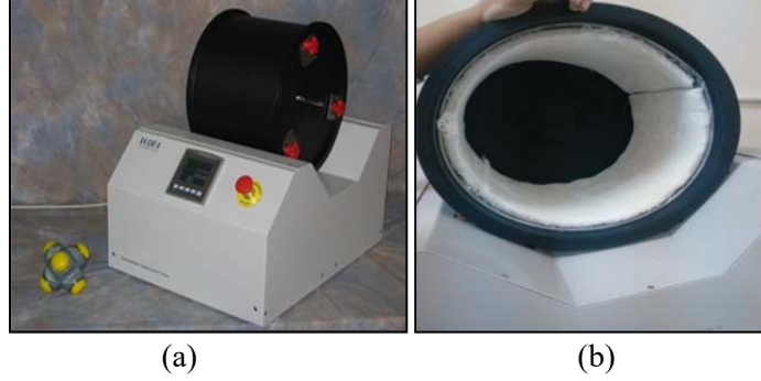
Şekil 3. 15. a) Wira Hekzapod test cihazı, b) Numune yerleşimi ( http://www.wira.com/media/other/37656/WiraHexapod2011.pdf )
