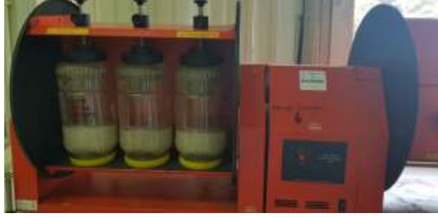
Şekil 4.73 Saf su ile eluat hazırlanması
