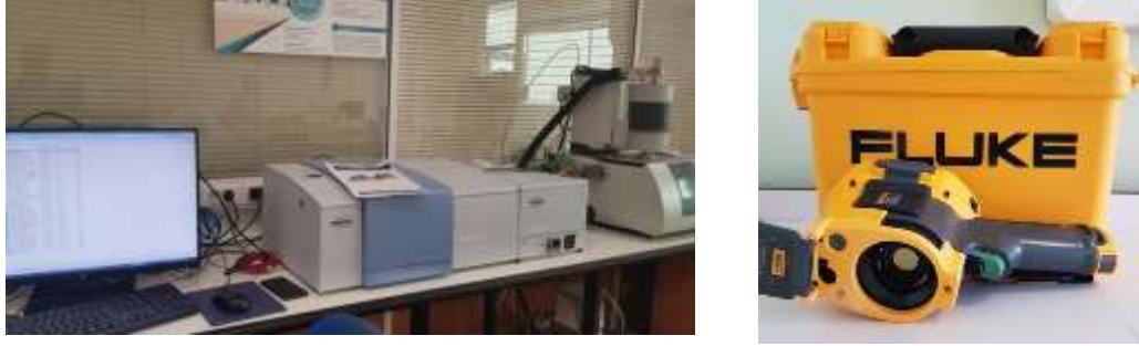
Şekil 4.27 TG analiz cihazı ve termal kamera
