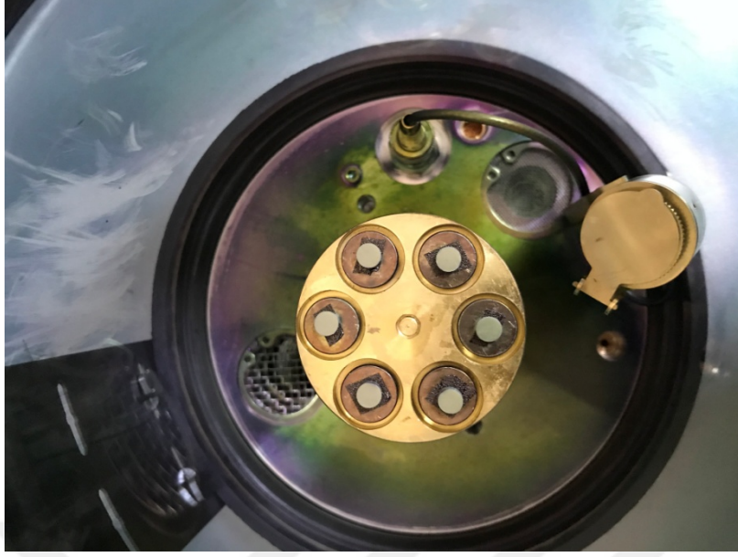
Şekil 3.14. SEM analizi için örneklerin altın ile kaplanması
