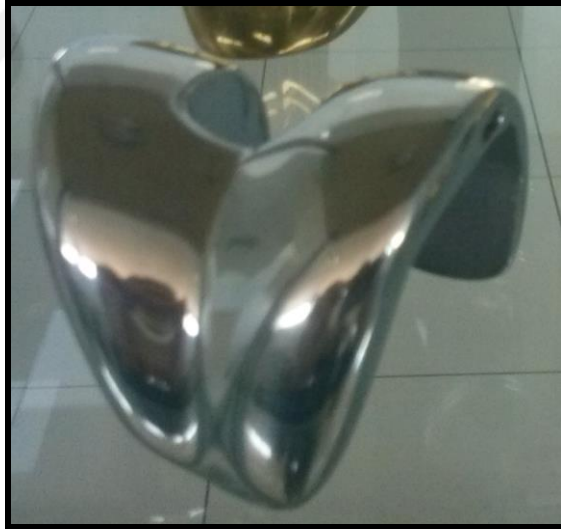
Şekil 3.6. Hassas döküm ile üretilmiş CoCrMo alaşımı diz protezi bileşeni (uyluk kemiğine sabitlenmektedir.)
