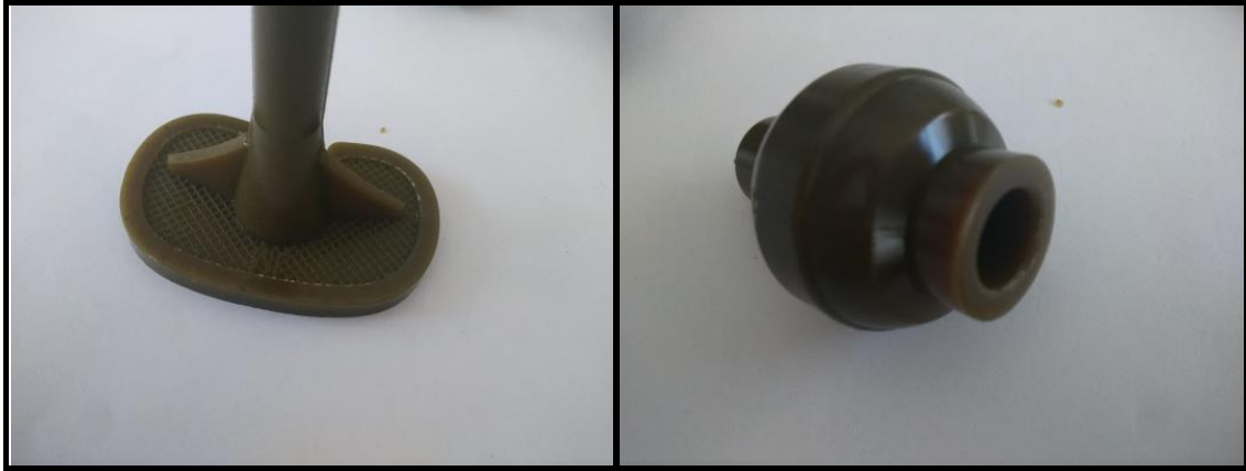
Şekil 3.2. Hassas döküm ile üretimi yapılacak diz ve kalça bileşenlerin mum modelleri
