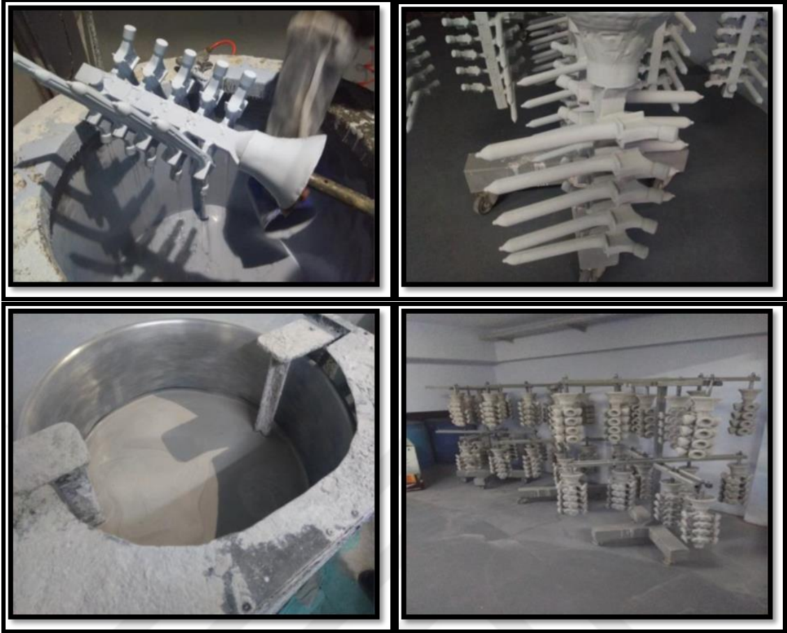
Şekil 3.3.Seramik kabuk oluşturma işlemi
