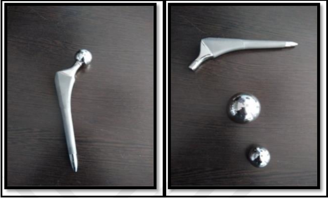
Şekil 3.7. Hassas döküm yöntemiyle üretilen CoCrMo kalça protezi bileşenleri sırasıyla; stem (uyluk kemiğine yerleştirilmektedir), kap (asetabulum boşluğuna yerleştirilmektedir), baş (hareket aktarımı sağlaması için stem başına sabitlenmektedir)
