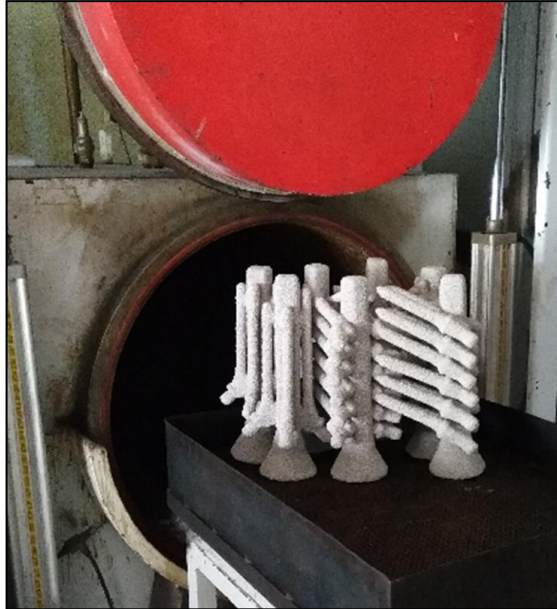
Şekil 3.4.Otoklav vasıtası ile kalıplarda mum boşaltma işlemi
