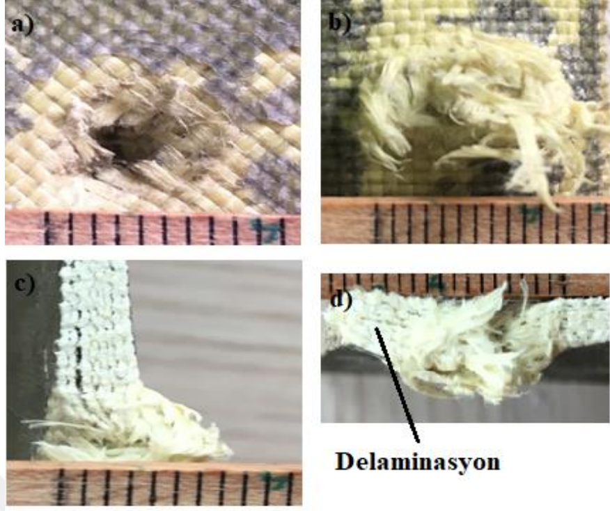
Şekil 4. 69. Atış yapılan 45°Kevlar4 plakanın a) mermi giriş çapı b) mermi çıkış çapı c) yarıma yüksekliği d) delaminasyon görüntüsü
