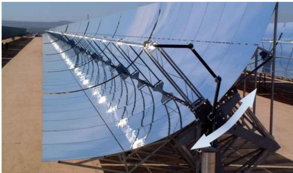
Şekil 2.21 : Parabolik oluk tipi ısı güneş enerji sistemi (Url-3.).
