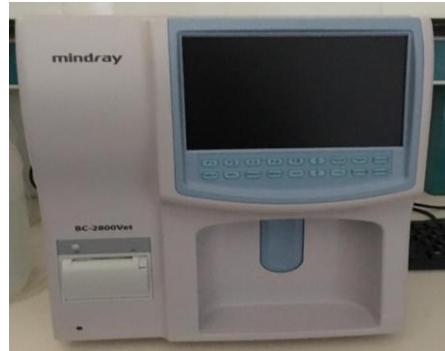
Şekil 4.2. Mindray BC2800 vet marka otomatik tam kan sayım cihazı.
