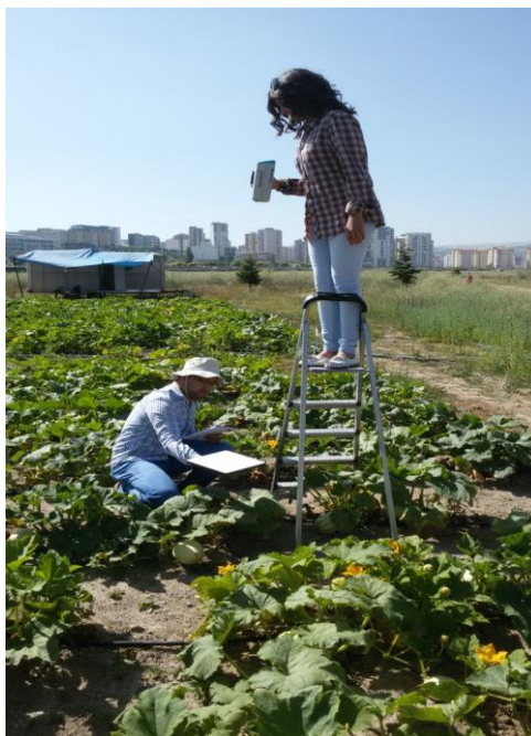
Şekil 2.5. Spektrometre ile deneme parsellerinde ölçüm yapılması
