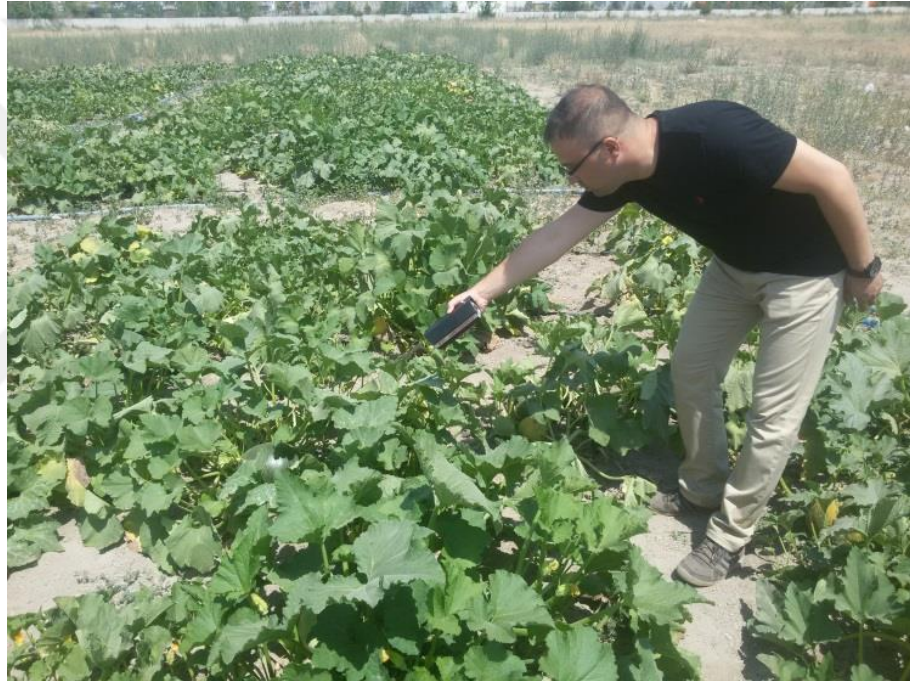
Şekil 2.6. İnfrared termometre ile bitki örtü sıcaklığının ölçülmesi
