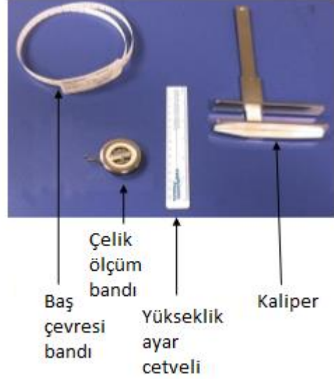
Şekil 2.7. Baş çevresi bandı, çelik ölçüm bandı, yükseklik ayar cetveli, kaliper
