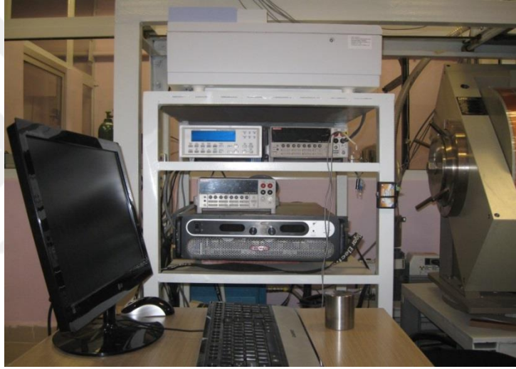
Şekil 4.7. I-V karakteristiklerini almak için kullanılan deney düzeneği
