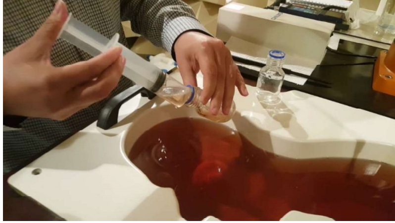
Şekil 5.2. Doku fantom sıvısından numune alınması
