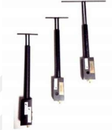
Şekil 5.6. PGM SAR Laboratuvarında 900 MHz, 1800 MHz ve 2000 MHz Frekanslarında Kullanılan Dipol Antenler
