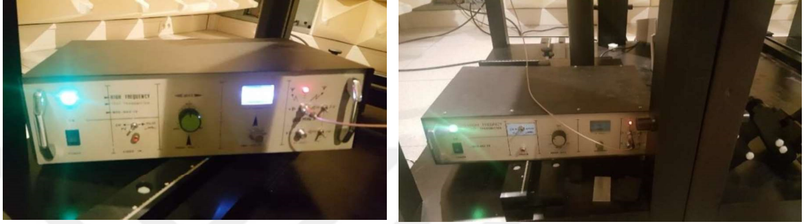
Şekil 4.19. 900MHz ve 1800 MHz’de çalışan GSM Sinyal Üreteçleri
