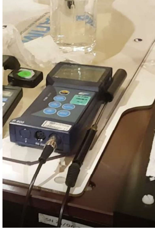
Şekil 4.15. PGM SAR sisteminde kullanılan problu termometre
