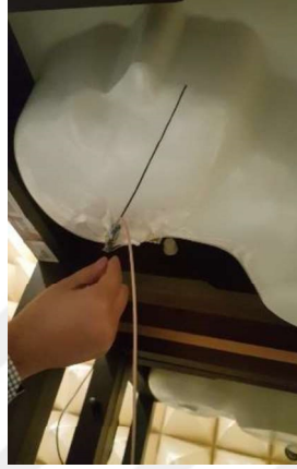
Şekil 4.20. GSM Sinyal Üreteci anteninin kafa fantomuna hizalanması
