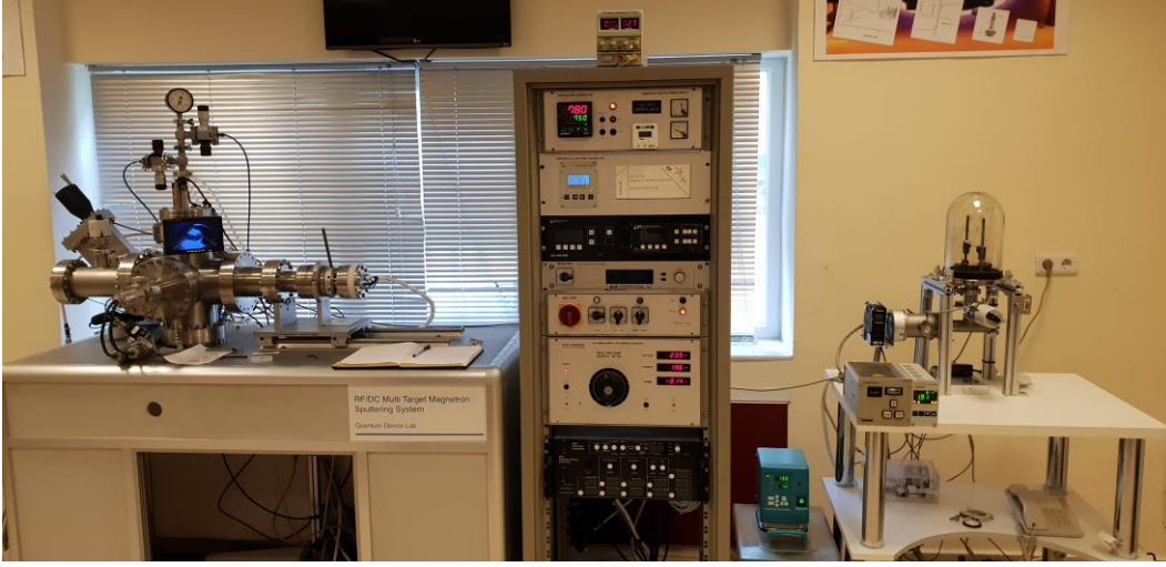
Şekil 5.14 Halojen alttaş ısıtıcısı kullanılarak UHV Multi-target DC/RF Magnetron Sputter sistemi ile YBCO ince film büyütülürken.
