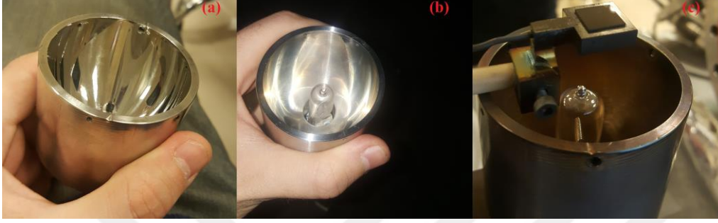
Şekil 5.12 Heater bloğunun maksimum sıcaklığa bağlı korozyon durumu: (a) polisajlanıp hiç kullanılmamış; (b) 10 saat maksimum sıcaklıkta sürekli çalıştıktan sonra; (c) 10 saat maksimumda çalışmanın üzerine 5 kez YBCO ince film üretim süreci tamamlandıktan sonra.
