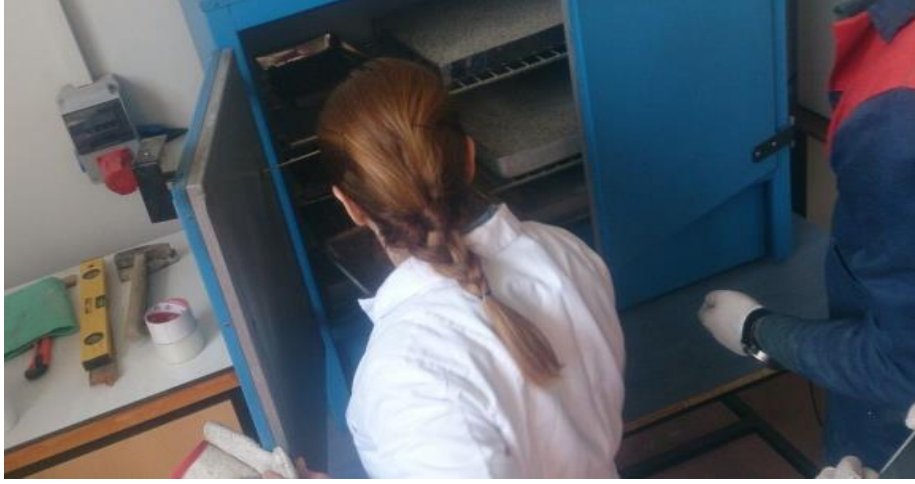
Şekil 4.28 Agregaların kurutulması (105°C).
