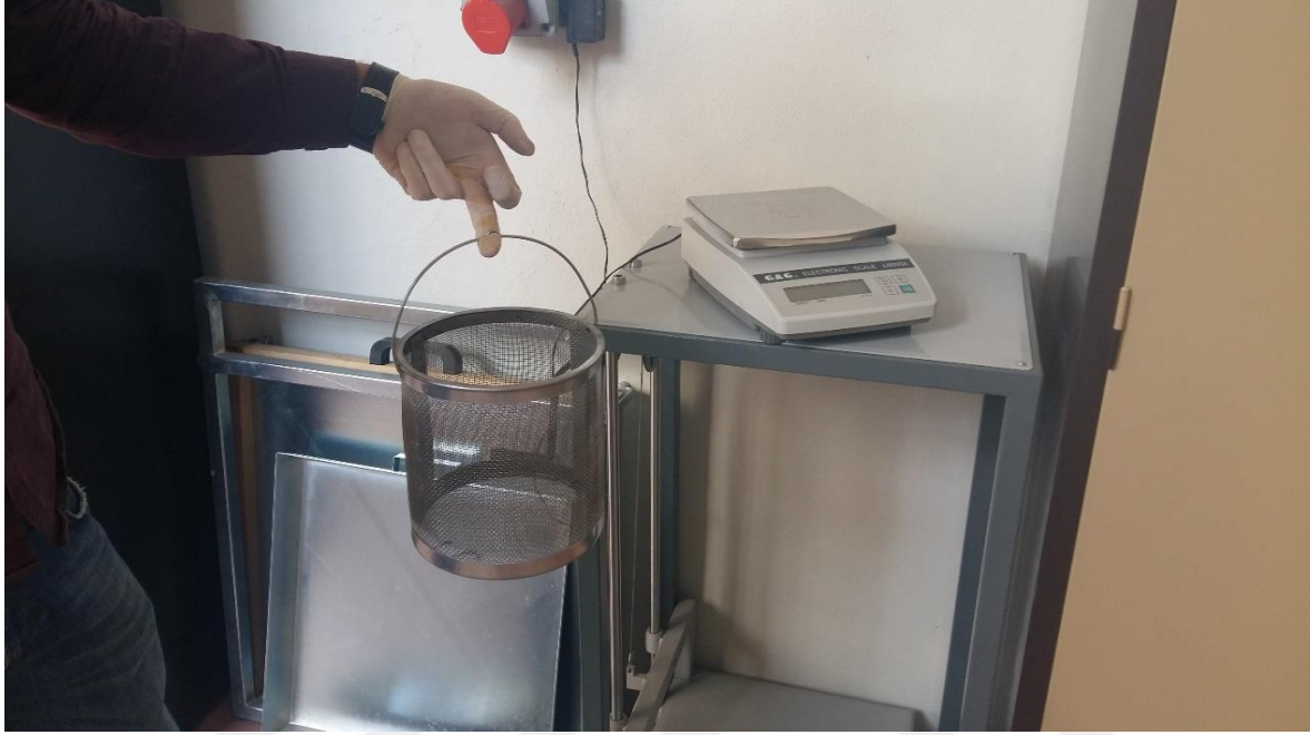
Şekil 4.12 Arşimet deney düzeneği.
