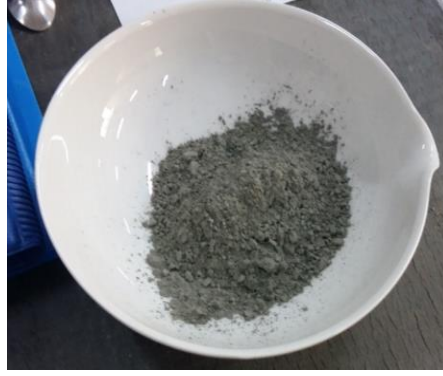
Şekil 4.20 Deney için hazırlanan 64 g çimento numunesi.
