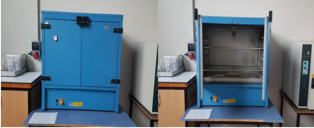
Şekil 4.10 (110\pm 5)^{\circ}\text{C} sıcaklığa ayarlanabilen etüv.
