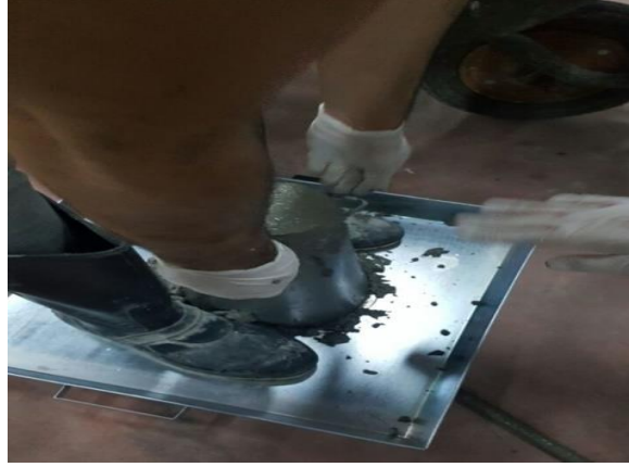
Şekil 4.45 Çökme konisini çekme işlemi.
