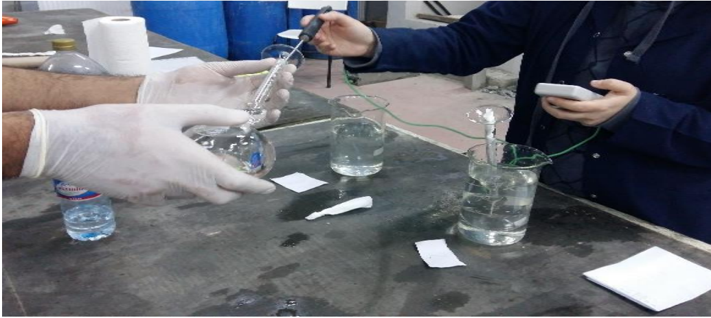
Şekil 4.23 Balon içindeki tiner ile suyun sıcaklıklarının belli sürelerle kontrolleri işlemi.
