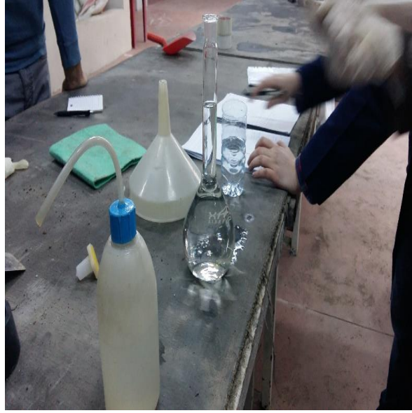
Şekil 4.35 Balon jojenin su ile doldurulması.
