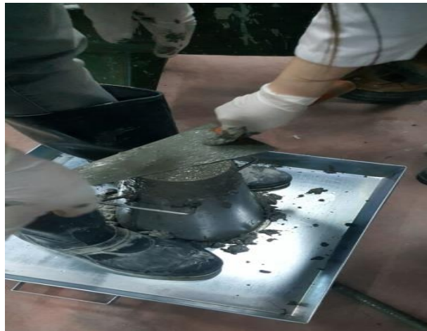
Şekil 4.44 Beton yüzeyinin masterlanması.
