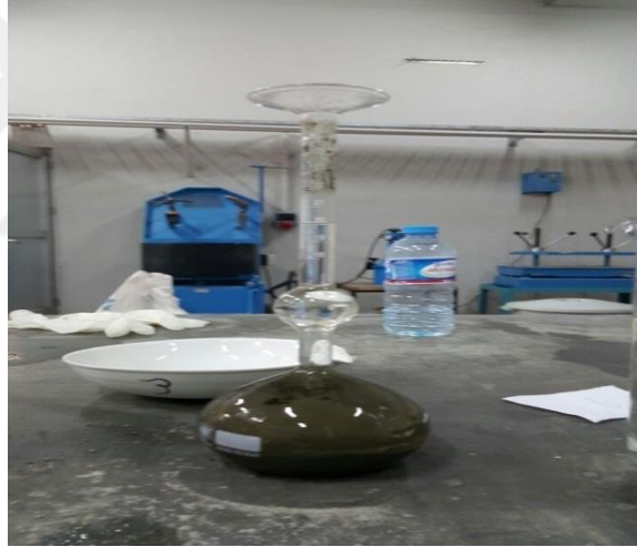
Şekil 4.25 64 g çimento numunesinin tamamının ölçü kabına aktarılması.
