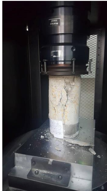
Şekil 5.13 Silindir numuneninin kırıldıktan sonraki görüntüsü.
