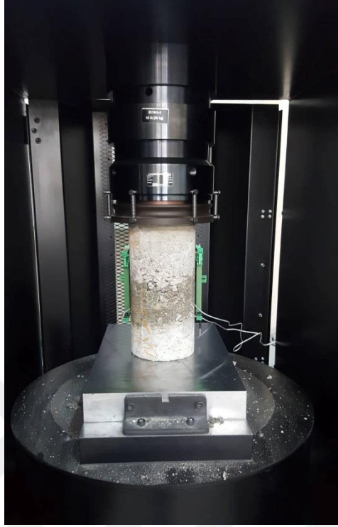
Şekil 5.12 Extensometer ile silindir numunelerin kırım aşaması.
