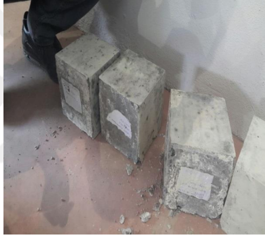
Şekil 4.54 Basınç testi sonrası kırılmış numuneler.
