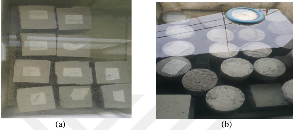
řekil 4.17 (a) Kp numunelerin (b) Silindir numunelerin kr havuzunda bekletilmesi.
