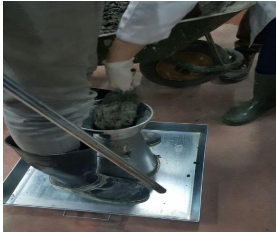
Şekil 4.42 Betonun çökme konisine yerleştirilmesi.
