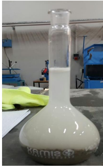
Şekil 4.36 Numunenin balon joje içine aktarılması.
