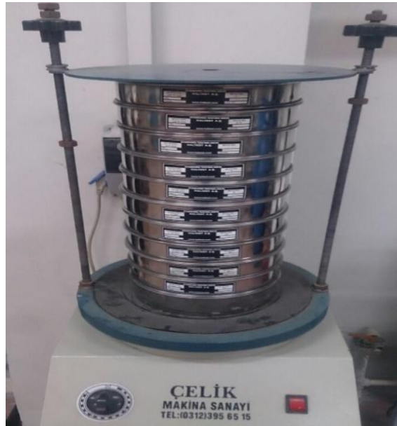
Şekil 4.11 Elek takımı ve elek sarsma makinası.
