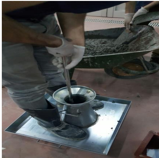
Şekil 4.16 Slump deney seti.
