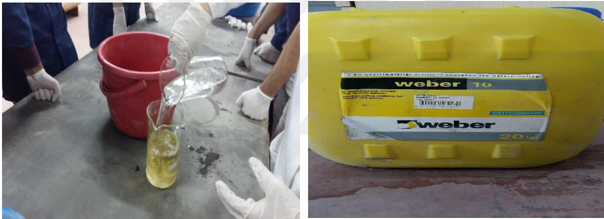
Şekil 4.7 Su azaltıcı katkı maddesi olarak kullanılan hiper akışkanlaştırıcı.
