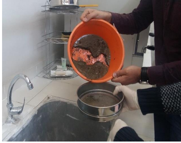
Şekil 4.33 Suyu doymuş hale gelmiş 0-5 mm agreganın suyunun süzülmesi.
