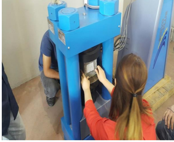
Şekil 4.53 Numunenin prese yerleştirilmesi.
