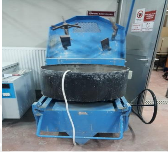
Şekil 4.15 TS EN 1766'ya uygun pan tipi mikser.
