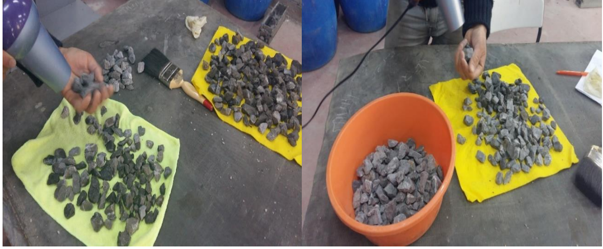
Şekil 4.39 15-25 mm agreganın DKY haline getirilmesi.
