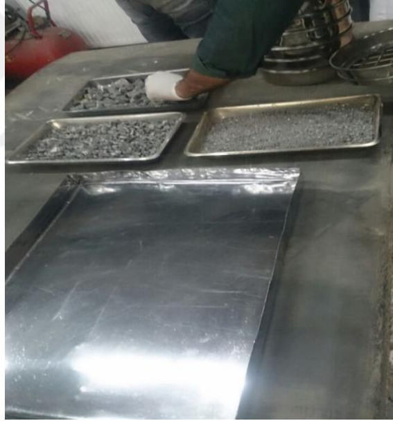
Şekil 4.29 Doygun yüzey kurusu (DKY) agregalar.
