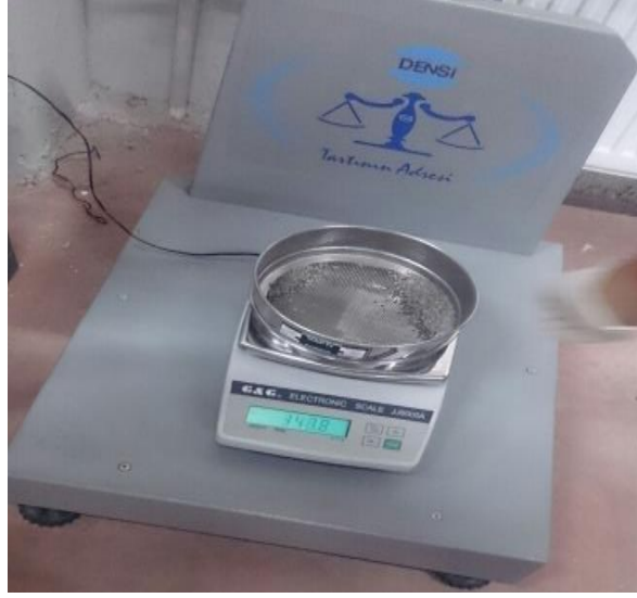
Şekil 4.31 Elek üzerinde kalan malzemenin hassas terazide tartılması.
