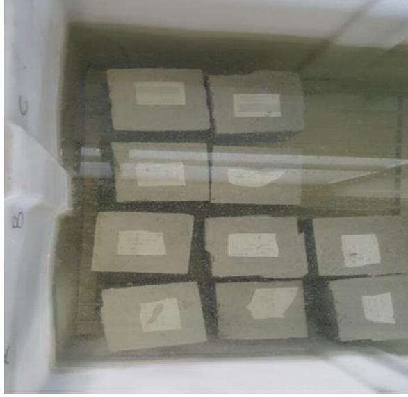
Şekil 4.51 Numunelerin kür havuzunda bekletilmesi.
