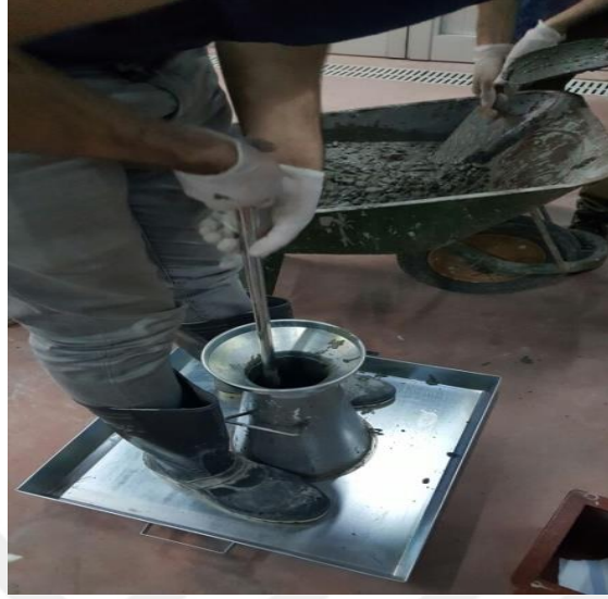
Şekil 4.43 Çökme konisine yerleştirilen taze betonun şişlenmesi.
