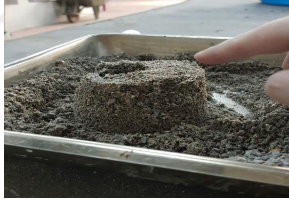
Şekil 4.34 0-5 mm agreganın DKY haline getirilmesi.
