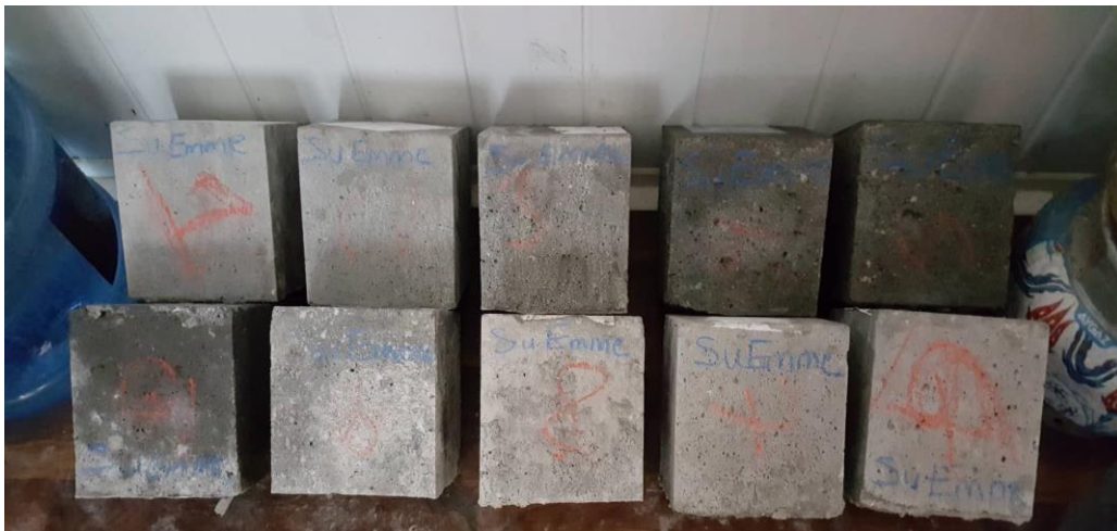
Şekil 4.47 24 saat boyunca 100^\circ C 'deki etüvde bekletilmiş beton numuneler.
