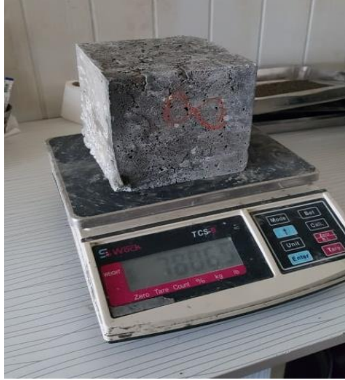
Şekil 4.48 Numunelerin ağırlığının hesaplanması.
