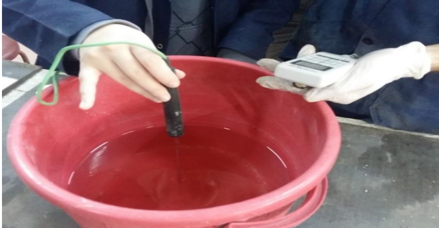
Şekil 4.21 Su banyosu için kullanılacak suyun sıcaklığının termometre ile kontrolü.
