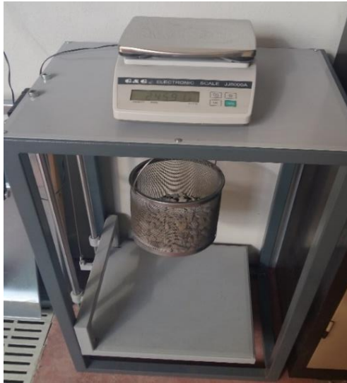
Şekil 4.40 Agregası numunesinin kuru halde tartılması.
