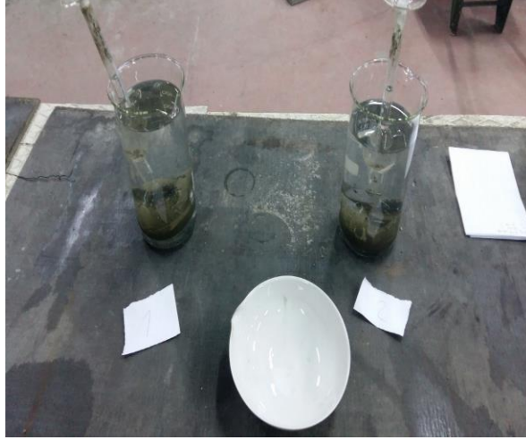
Şekil 4.26 Su banyosuna bırakılan Le Chatelier balonları.
