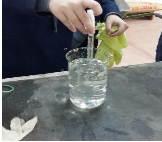
Şekil 4.22 İçerisine tiner koyulan Le Chatelier balonunun su banyosuna bırakılması.
