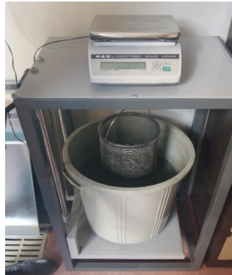
Şekil 4.41 Agregası numunesinin sudaki ağırlığı ile tartılması.
