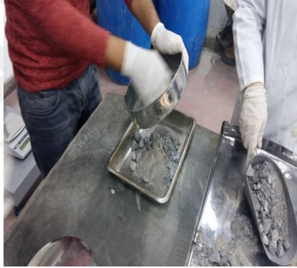
Şekil 4.32 Eleklerde kalan malzemelerin ayrı bir tepside toplanması.
