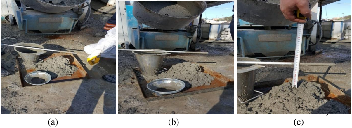
Şekil 4.46 (a), (b) ve (c) Çökme miktarının ölçülmesi.
