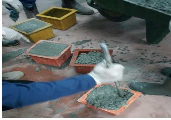
Şekil 4.49 Numunenin kalıba yerleştirilmesi.
