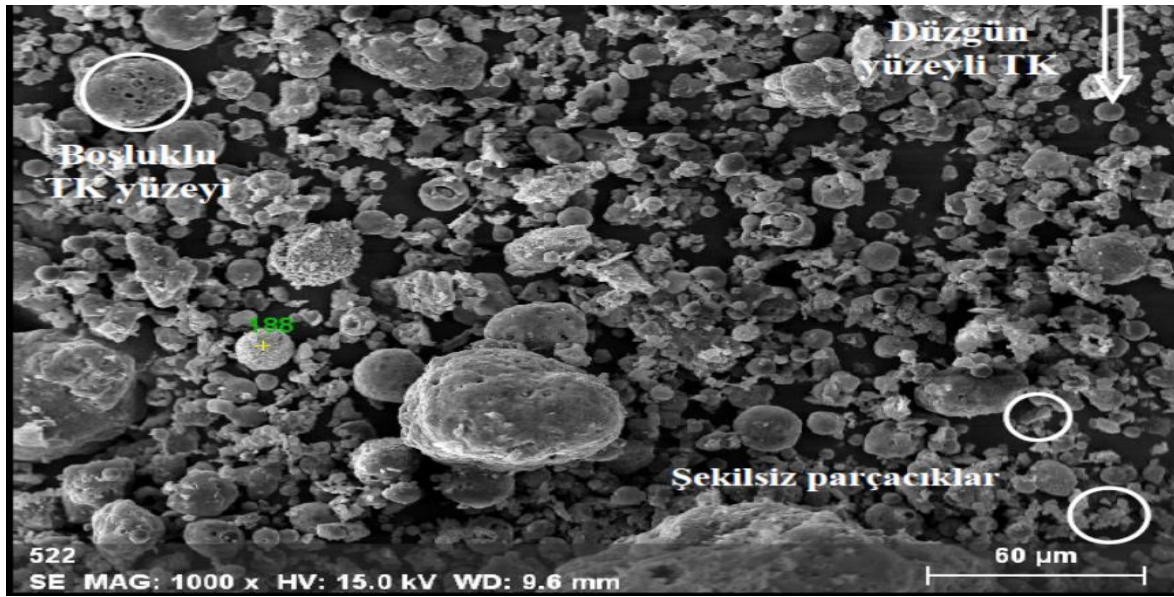
Şekil 3.1 Öğütülmüş TK'nün 2000 büyütme mikroyapısı [33].
