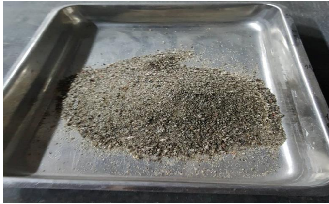
Şekil 4.6 Bolu Çimento A.Ş' den temin edilen GYFC numune örneği.
