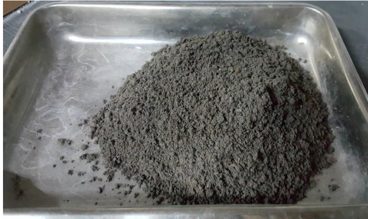
Şekil 4.4 Eren Enerji A.Ş taş ocağından temin edilen taban külü numunesi.
