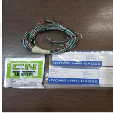
Şekil 3.7 Strain gauge (gerinim pulu) ve yapıştırıcısı örneği.
