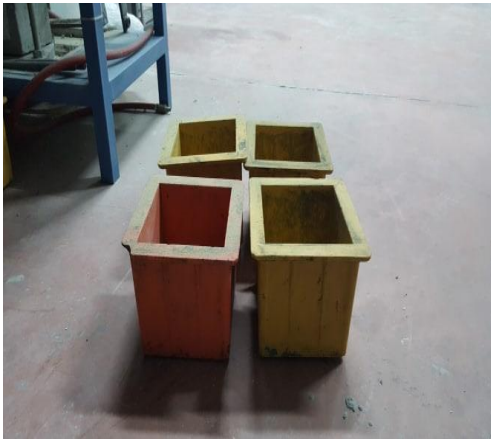
Şekil 4.13 Küp numune kalıbı.
