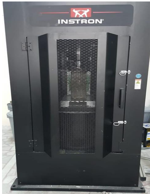
řekil 4.18 INSTRON 1000 RD beton basıncı test cihazı.
