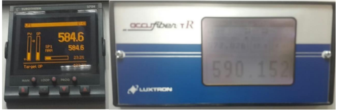
Şekil 5.4 MOCVD sistemi sıcaklık kontrol üniteleri. Solda alttan ölçüm kontrolcüsü sağda ise alttaş yüzeyinden yapılan ölçüm sistemi gösterilmektedir.
