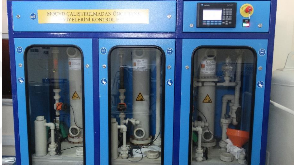
Şekil 5.7 MOCVD sisteminin çıkışında bulunan artık gazların etkisiz hale getirilip biriktirildiği sıvı “scrubber” sistemi.
