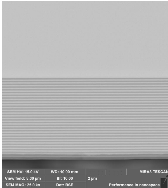
Şekil 6.6 VCSEL017 numaralı büyütmeye ait SEM görüntüsü.
