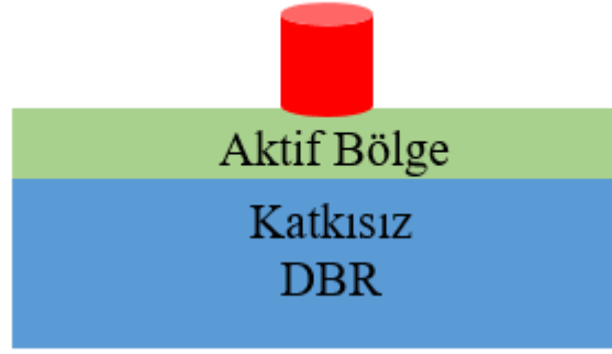
Şekil 2.11 Yüzey ışıklı VCSEL yapısı.
