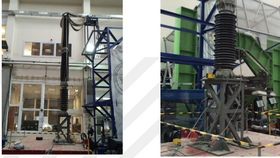
Şekil 2.49 : Ankastre mesnetlenmiş deney düzeneği.
