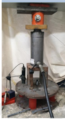
Şekil 2.11 : Sismik yalıtım cihazı ön eksenel yükleme düzeneği.
