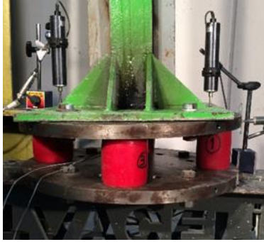
c. Poliüretan yaylar ile oluşturulan sismik yalıtım cihazları.
