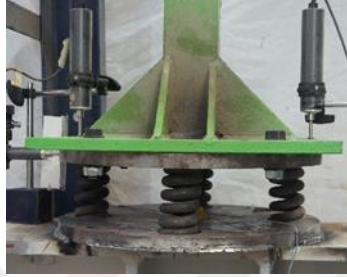
b. Çelik yaylar ile oluşturulan sismik yalıtım cihazı.
