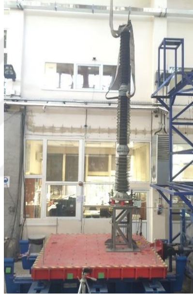
Şekil 2.28 : ARI-1 sarsma masası ve tipik deney numunesi.
