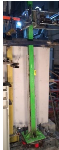
Şekil 2.12 : Çevrimsel yükleme deney düzeneği.
