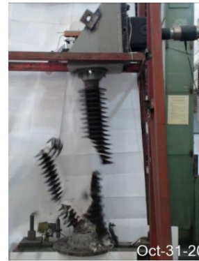
Şekil 2.26 : Numune-2 göçme durumuna ait anlık fotoğraflar.
