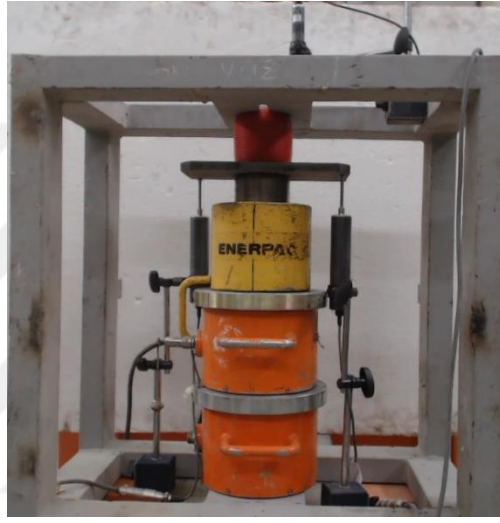
b. Eksenel yük deney şeması - \Delta=40\text{mm}
