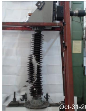
Şekil 2.26 : Numune-2 göçme durumuna ait anlık fotoğraflar.
