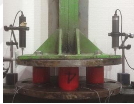
c. Poliüretan yaylar ile oluşturulan sismik yalıtım cihazları.
