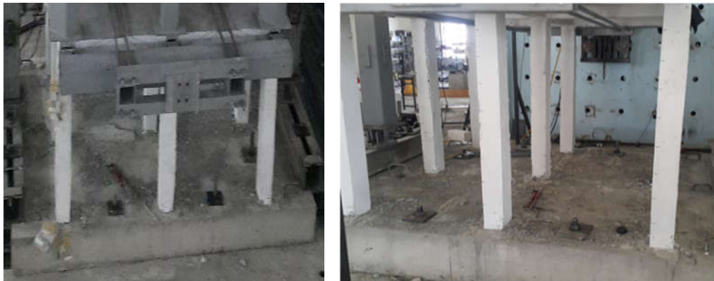
Şekil 2.73. Deney numunelerinin rijit döşeme üzerine ankrajlanması.
