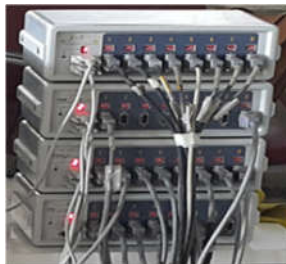
Şekil 2.87. Güçlendirme deneylerinde kullanılan veri toplama (Data Logger) sistemi.
