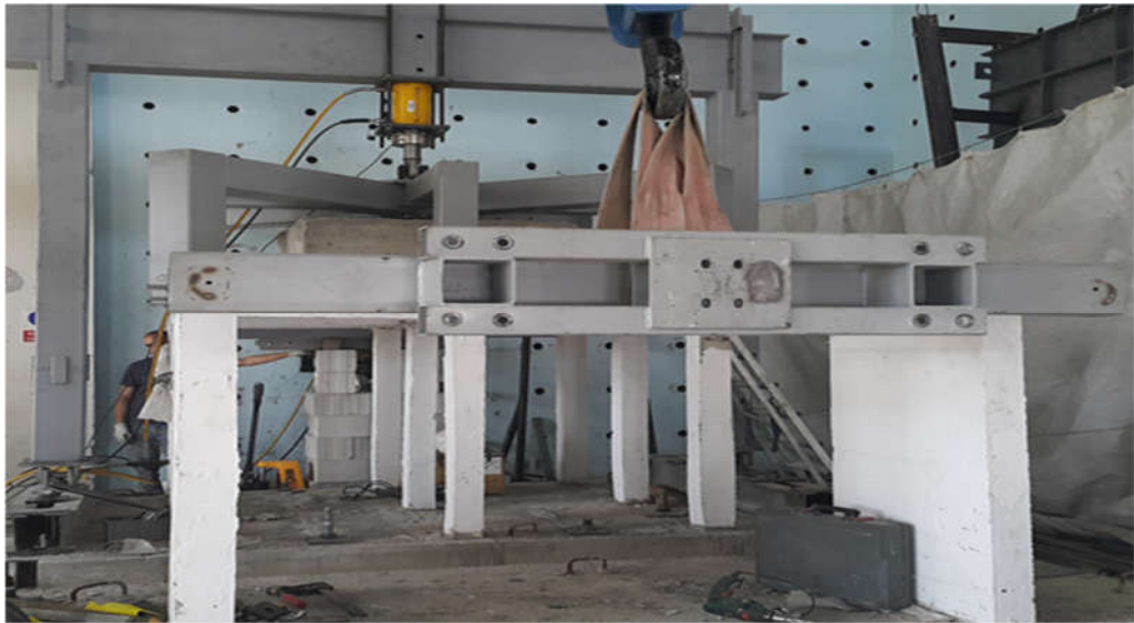
Şekil 2.83. Yatay yükleme levhalarının perdelere bağlanması.
