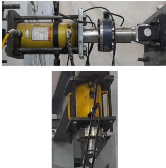
Şekil 2.67. Deneylerde kullanılan yük hücreleri.
