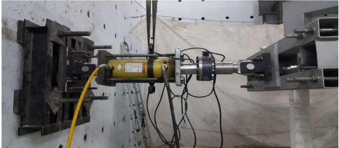
Şekil 2.76. Yatay yükleme için kullanılan hidrolik krik ve bağlantı detayı.
