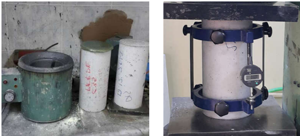
Şekil 2.33. Silindir numunelere kükürt başlık yapılması ve uzama okumaları için saat bağlanması.
