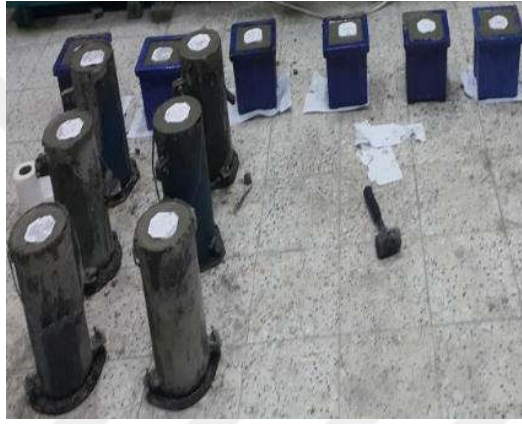
Şekil 2.30. Deney numunelerinden beton numunesi alınması ve kür havuzuna bırakılan numuneler.
