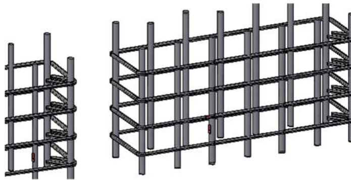
Şekil 3.86. Kolonlara ve perdelere temel seviyesinde yerleştirilen strain gaugeler.
