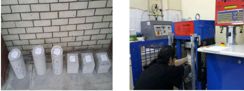
Şekil 2.32. Küp numunelerin beton basınç deneyi.
