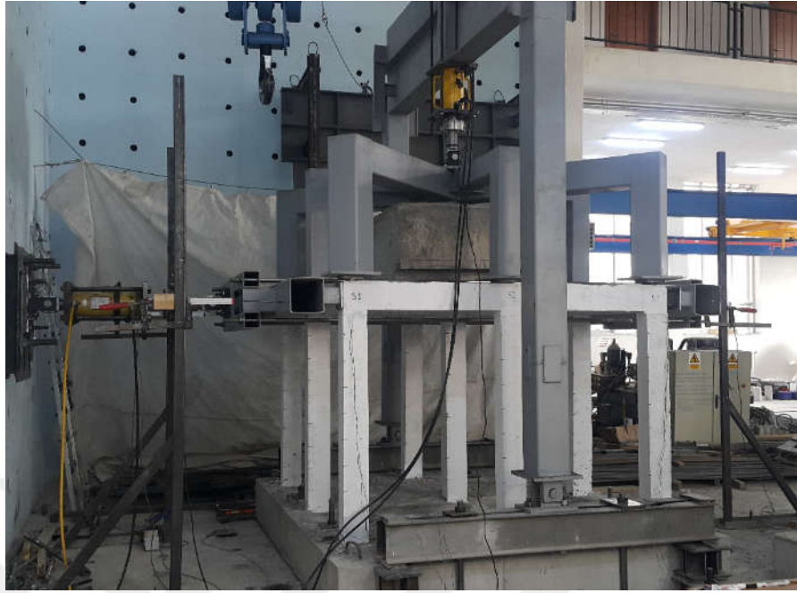
Şekil 3.27. 1.Deney (Referans Çerçeve) başlangıcında taşıyıcı sistemin görünümü.
