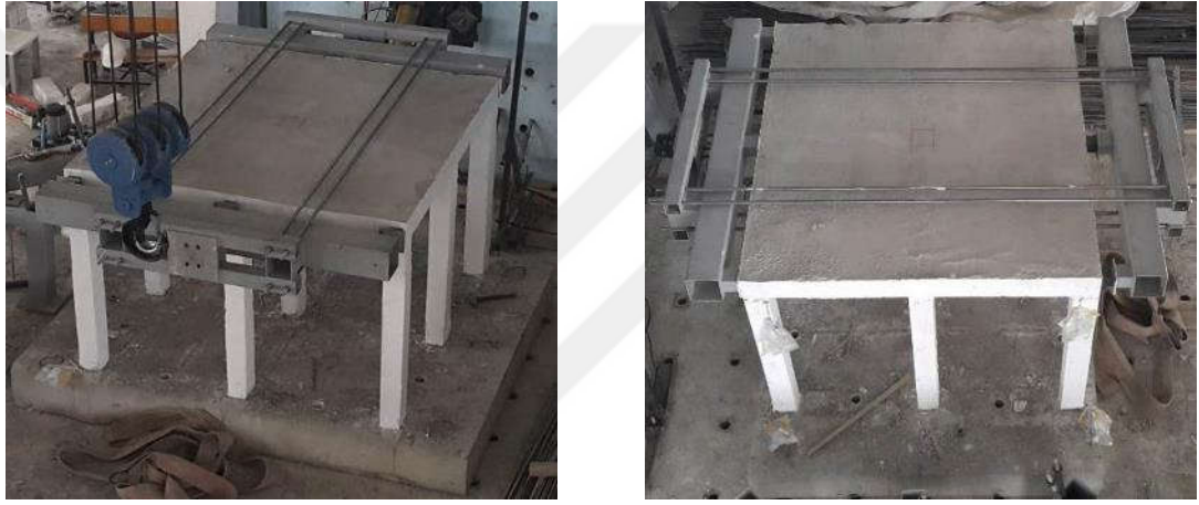
Şekil 2.74. Yatay yükleme düzeneğinin deney numunelerine sabitlenmesi.
