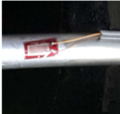
Şekil 2.71. FLAB-6 ve FLAB-2 strain gaugeler
