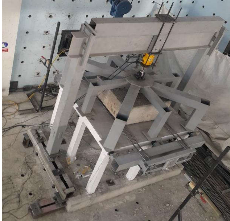
Şekil 2.78. Strain Gauge köprü kablolarının bağlantılarının yapılması.
