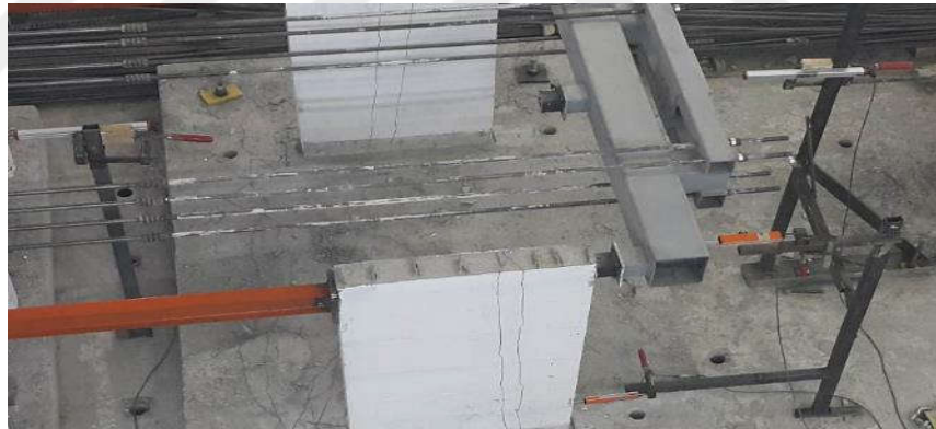
Şekil 2.86. Çerçevelerin güçlendirme perdeleriyle bağlandığı deneylerde kullanılan ölçüm düzeneğinin kurulumu.
