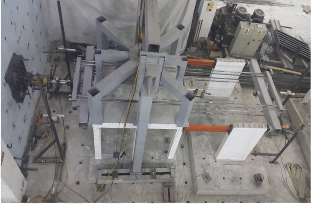
Şekil 2.88. Hasarlı çerçevenin dış perdelerle güçlendirilmesi deneyinde kullanılan deney düzeneği.
