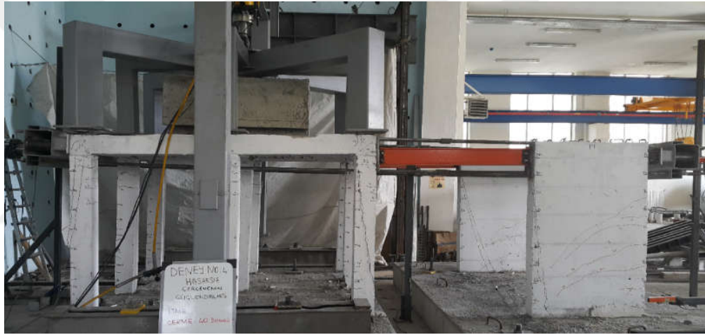
Şekil 3.62. 4.Deney sonunda çelik bağ kirişlerle bağlanan dış perdelerle güçlendirilmiş taşıyıcı sistemin görünümü.
