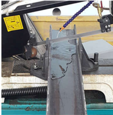
Çelik Bağ Kirişlerin Projeye Uygun Olarak Kesilmesi ve Üzerine Delik Açılması
