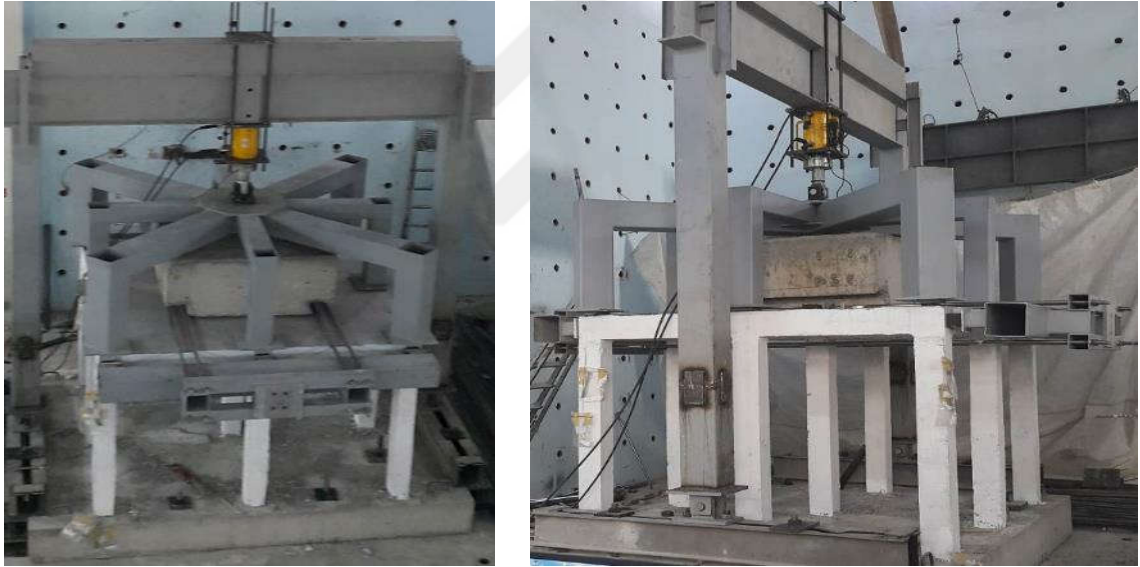
Şekil 2.75. Eksenel yükleme düzeneği ve çerçevesinin yerleştirilmesi.
