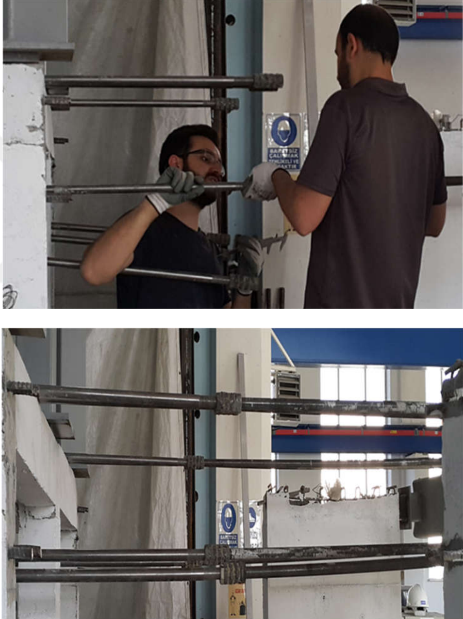
Şekil 2.84. Çerçevelerin güçlendirme perdeleriyle bağlandığı deneylerde kullanılan transmisyon millerine manşonlu ek yapılması.
