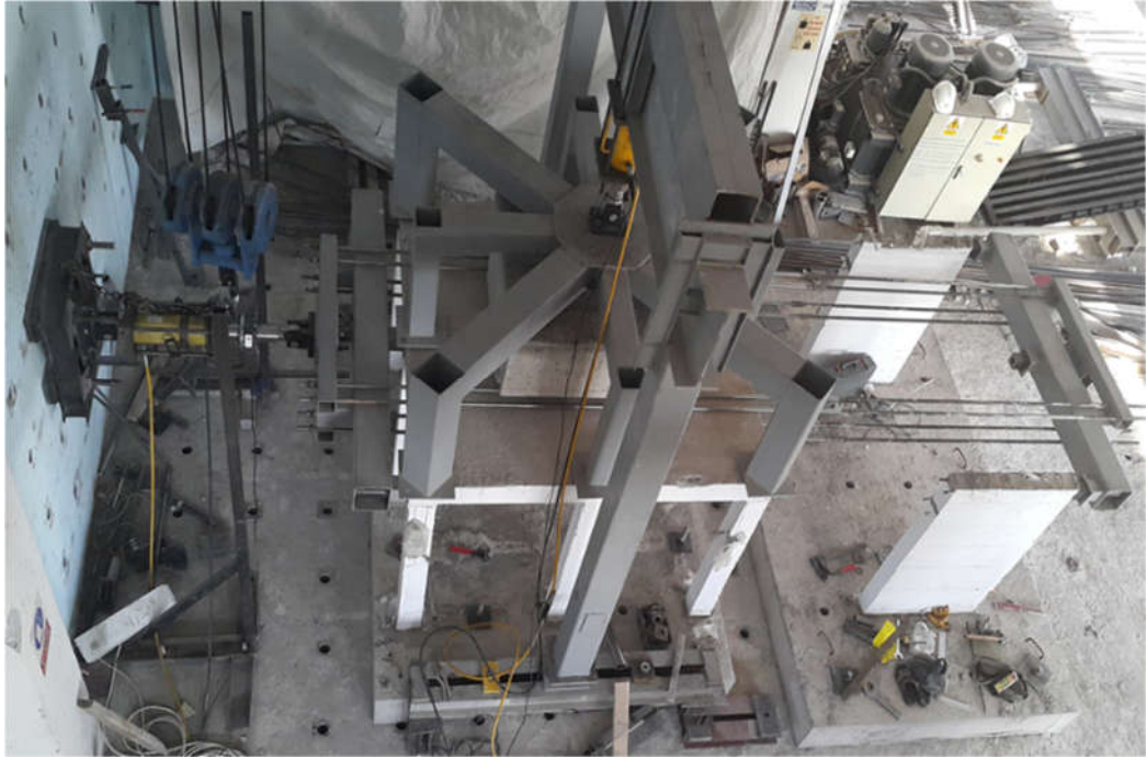
Şekil 2.85. Çerçevelerin güçlendirme perdeleriyle bağlandığı deneylerde kullanılan yatay yükleme düzeneğinin kurulması.
