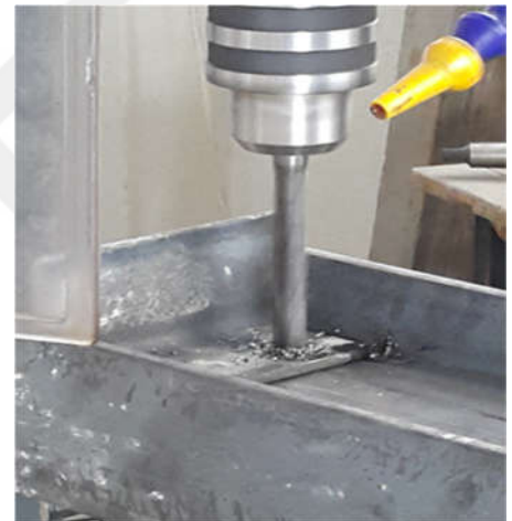
Çelik Bağ Kirişlerin Projeye Uygun Olarak Kesilmesi ve Üzerine Delik Açılması
