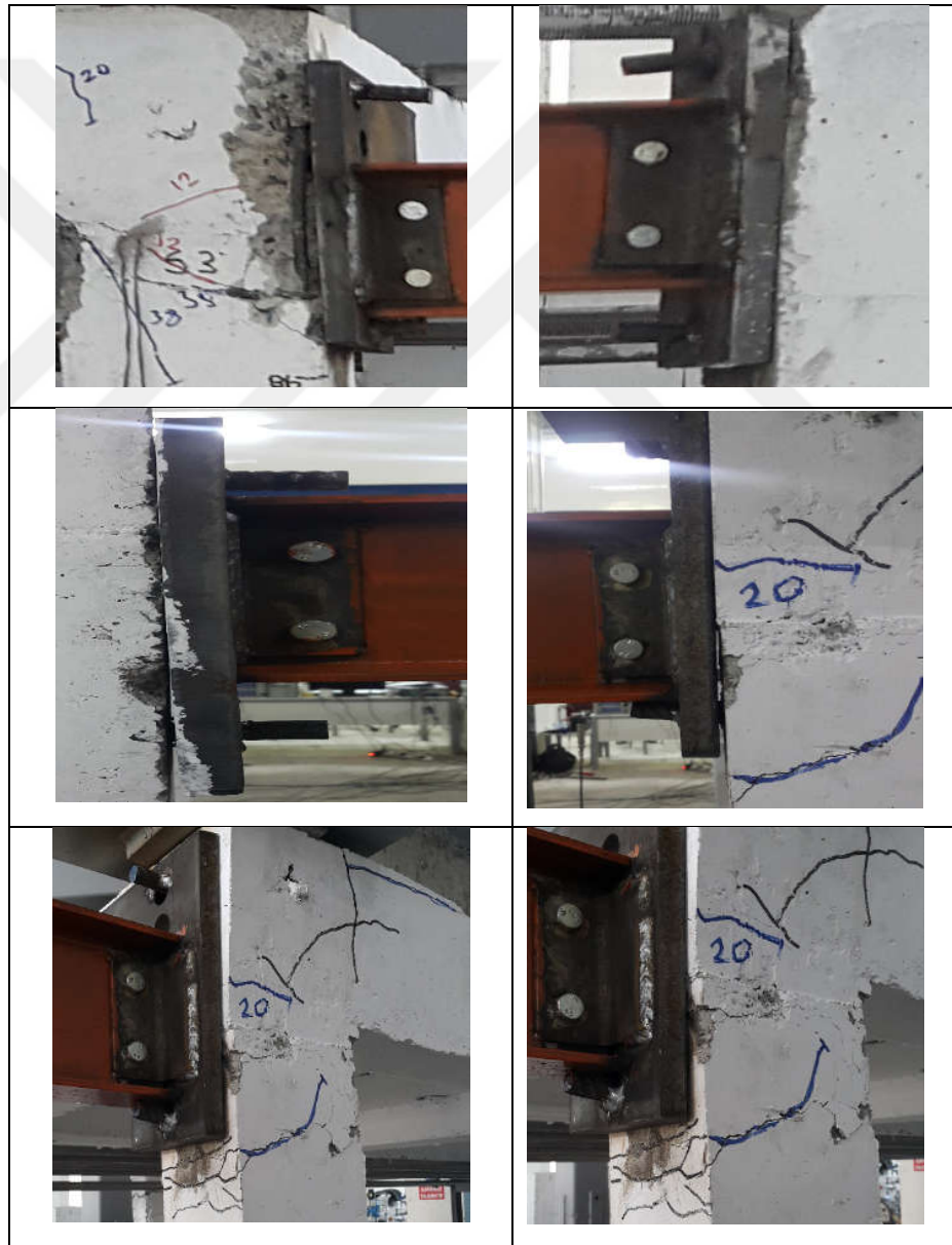
Şekil 3.48. Çerçeve ve dış perdeleri birbirlerine bağlayan bağ kirişlerin ankrajları.
