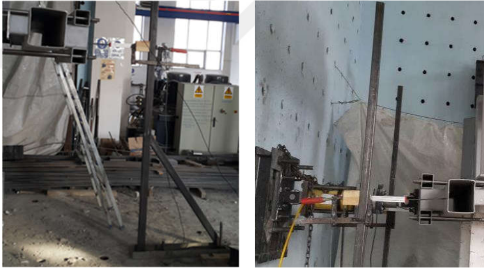
Şekil 2.68. Deneylerde kullanılan potansiyometrik cetveller
