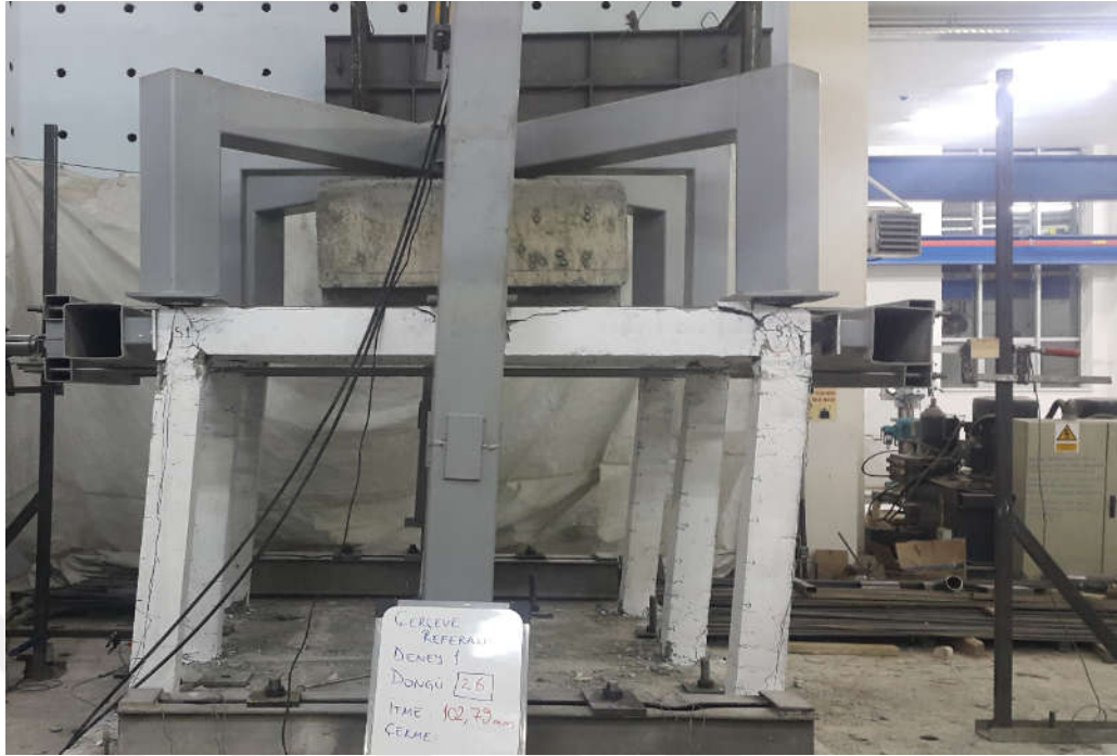
Şekil 3.33. 1.Deney (Referans Çerçeve) sonunda taşıyıcı sistemin görünümü.
