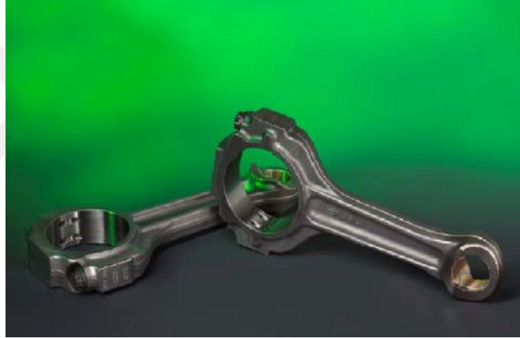
Şekil 3.13 : Corvette Z06 modelinde kullanılan Ti-6Al-4V bağlantı rodu [41].
