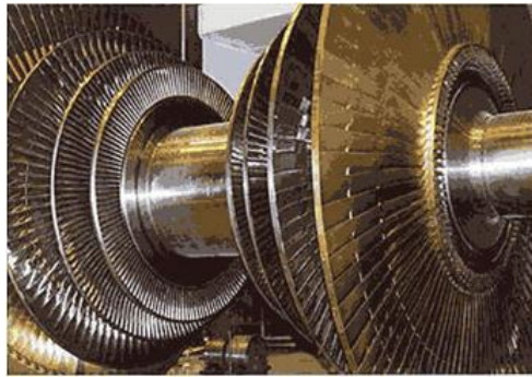
Şekil 3.25 : Nükleer enerji santralinin buhar türbininde kullanılan rotor [46].
