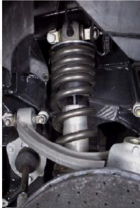
Şekil 3.20 : Ferrari Stradale 360 modelinde kullanılan titanyum alaşımı süspansiyon yayı [41].
