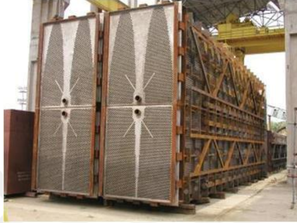
Şekil 3.26 : Rostov ve Balakovo nükleer enerji santrallerinde kullanılan buhar türbini kondansatör modülleri.
