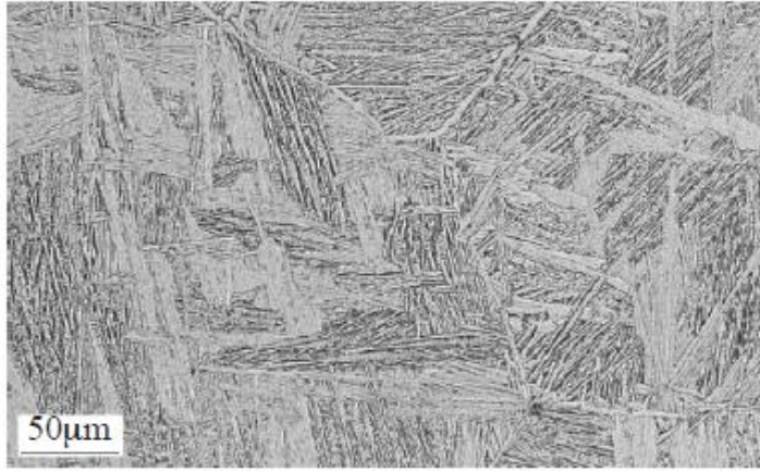
Şekil 3.15 : Ti-6Al-4V alaşımdan yapılmış motor giriş valfine ait enine kesit mikroyapı görüntüsü.
