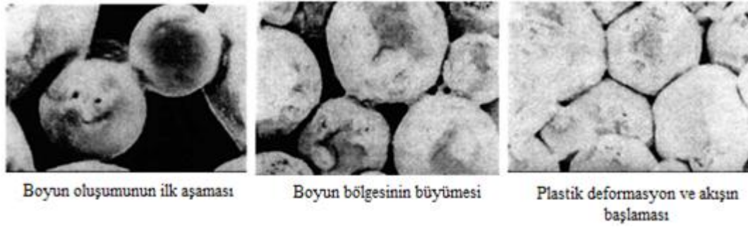
Şekil 4.14 : SPS’te boyun oluşumunu gösteren SEM görüntüleri.
