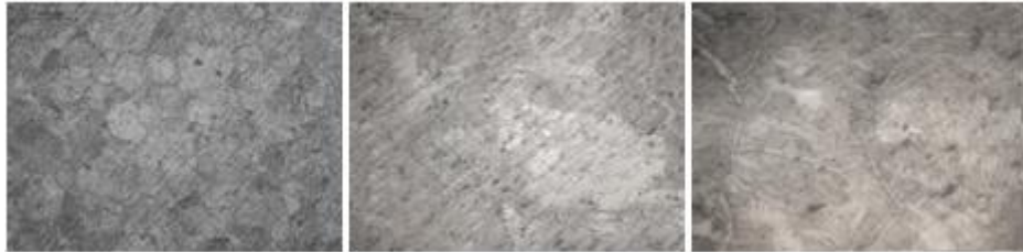
Şekil 6.11 : 1000°C’de 5 dk süreyle 50MPa basınç ve argon altında 200°C/dk ısıtma hızıyla SPS ile sinterlenen numune mikroyapıları (a) 100x büyütme, (b) 200x büyütme, (c) 500x büyütme.
