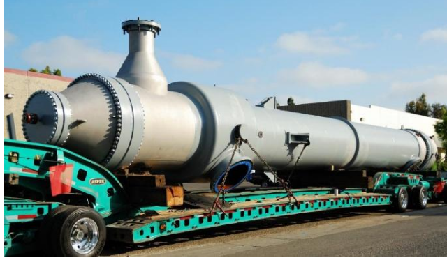
Şekil 3.24 : Grade 12 titanyum alaşımı ve 2205 dubleks paslanmaz çelikten imal edilmiş ısı dönüştürücüsü [45].
