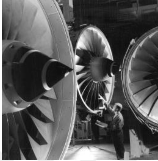
Şekil 3.8 : Rolls Royce Trent uçak motorlarında Ti-6Al-4V alaşımından yapılmış ön fanlar [1].
