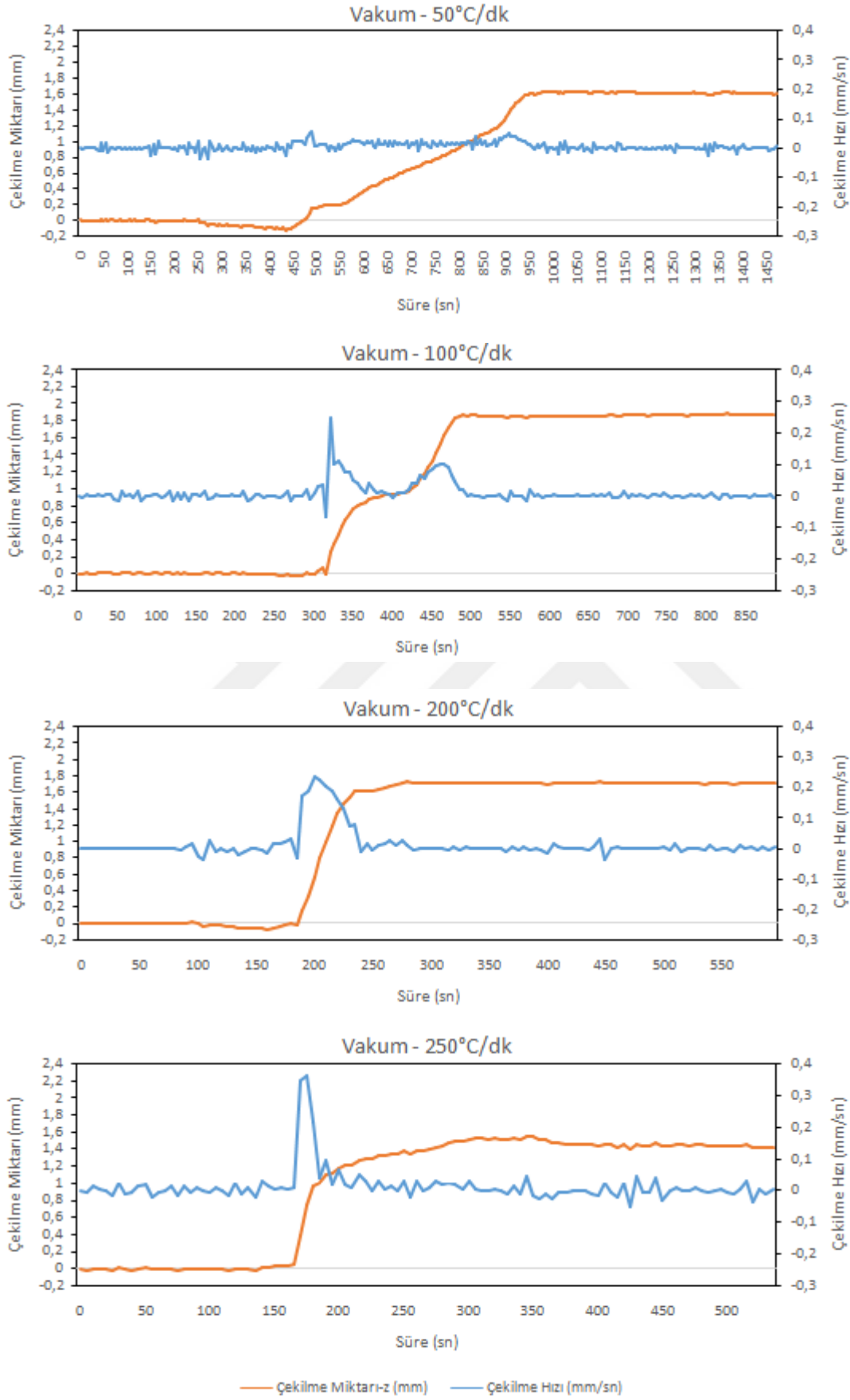
Şekil 6.1 : 1000°C’de 5 dk süreyle 50MPa basınçla vakum altında SPS ile sintirlenen numunelerin zamana göre çekilme miktarlarındaki değişim.
