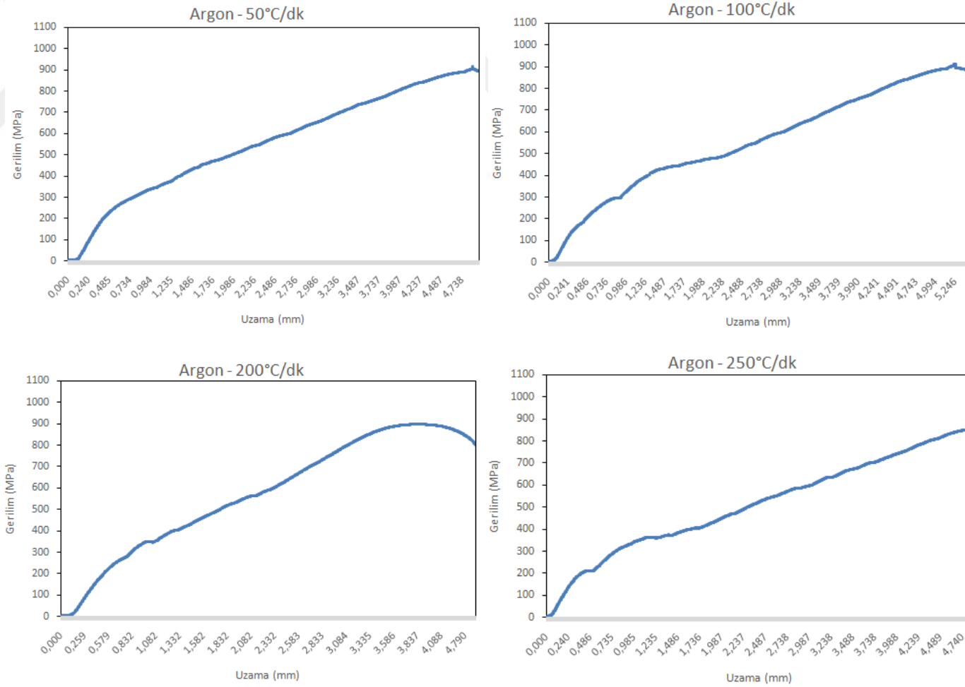
Şekil 6.15 : 1000°C’de 5 dk süreyle 50MPa basınç ve argon altında SPS ile sinterlenen numunelerin mühendislik gerilimi-uzama grafikleri.
