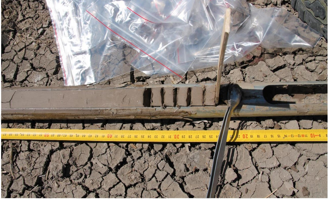
Şekil 1.4. Arazide alınan karotların dilimlenerek paketlenmesi
