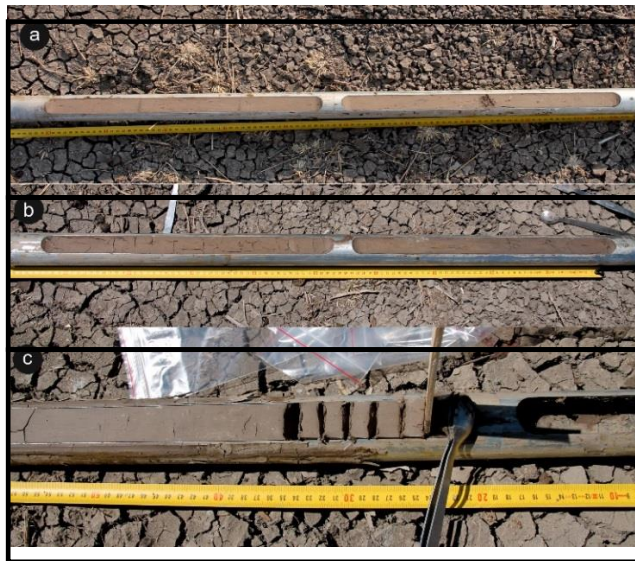
Şekil 4.2 Sondaj sonucu elde edilen karotlar (a-MG1, b-MG2) ve karotların örneklenmesi (c).
