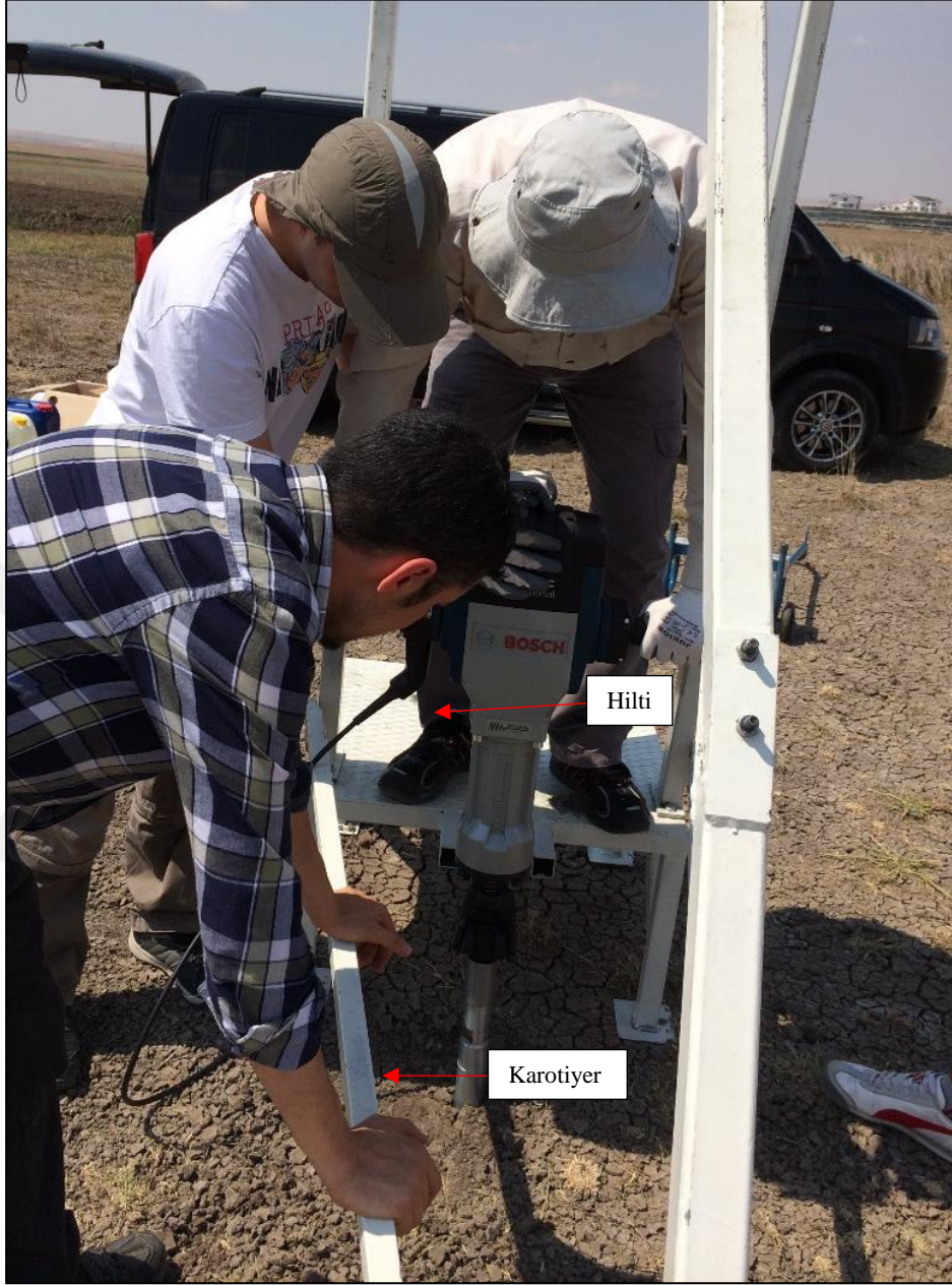
Şekil 1.3. El tipi sondaj makinesi ve sondaj yapımı
