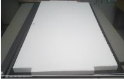
Kenar Boşaltmalı 5 dk–kırılmadı (0/1) 15 dk–büyük kırık (2/3)
