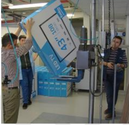
Şekil 4.17 Kontrollü test 2 kapsamında düşürme şekilleri
