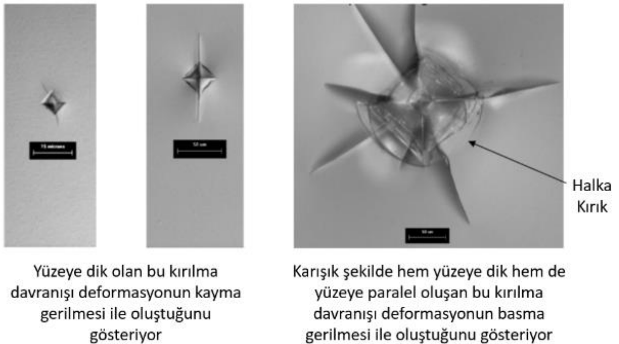
Şekil 3.8 Oluşan gerilmelerin kırılma şekline etkisi
