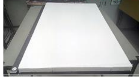
Komple – panel strafor-5 dk–kırılmadı (0/1) 15 dk–kırılmadı (0/3)
