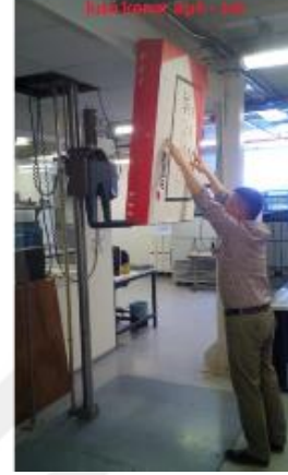
Şekil 4.17 Kontrollü test 2 kapsamında düşürme şekilleri
