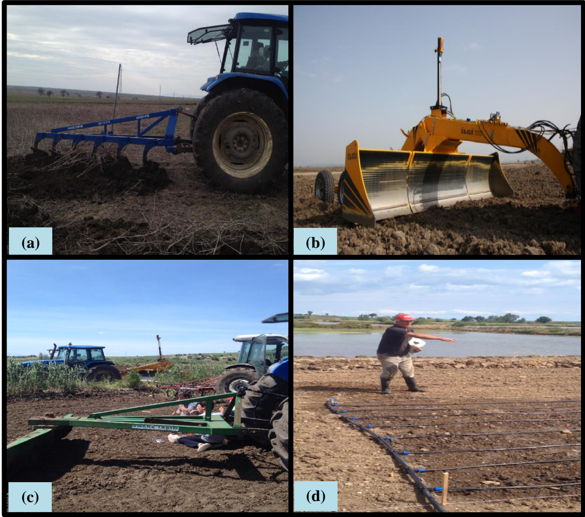
Şekil 3.7. Pullukla sürüm (a), lazerli tesviye (b), toprak işleme ve tirlerin oluşturulması (c), tohumların el ile saçılması (d)
