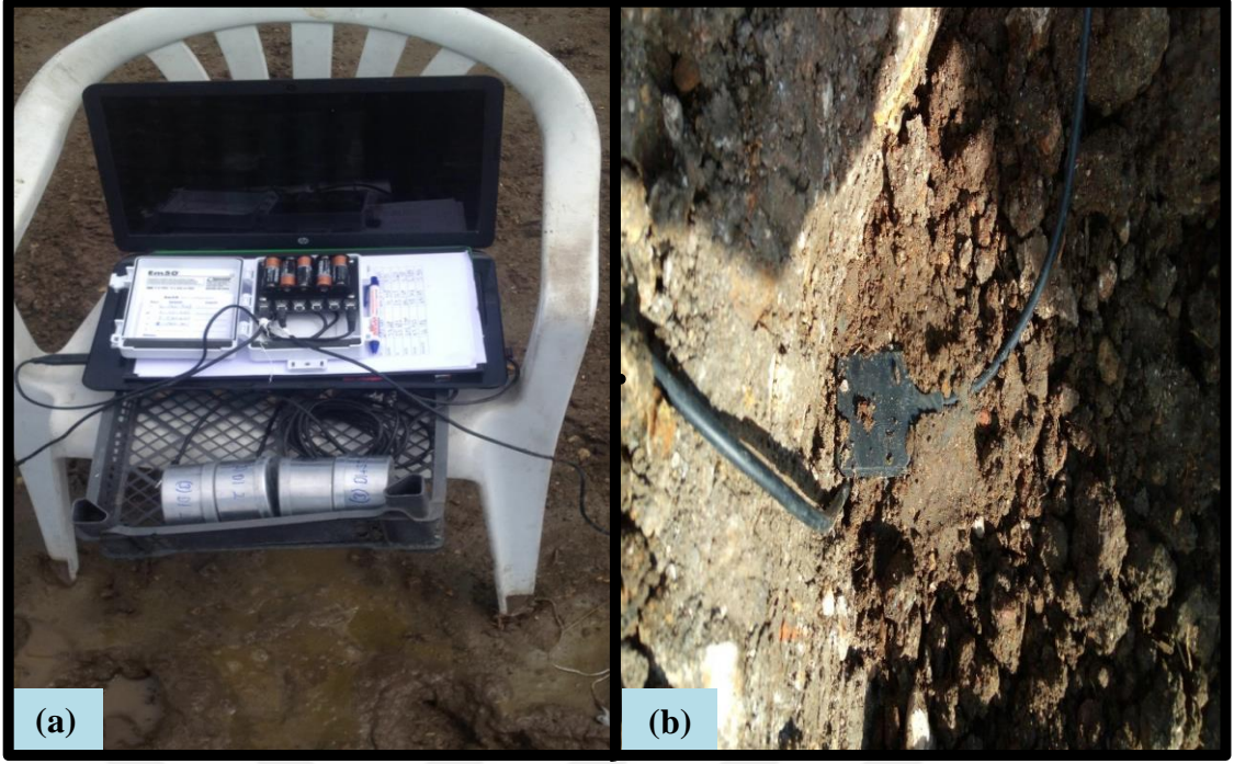
Şekil 3.9. Toprak neminin bilgisayar aracılığı ile decagon Em50 ECH 2 O loggerla takibi (a), Toprak nem sensörlerini yerleştirilmesi (b)
