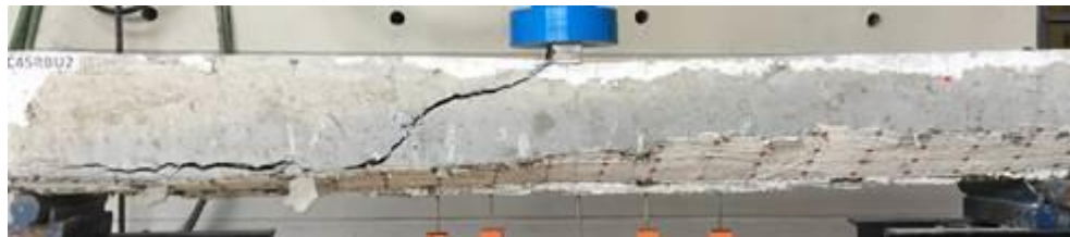
Şekil 3.7 Deney öncesi ve sonrası C4.5RBU2 kirişi görünümleri ((a)Yüklemeye başlamadan önce C4.5RBU2 kirişi ön yüzü, (b) Güç tükenmesine oluşumu sonrası C4.5RBU2 kirişi ön yüzü)
