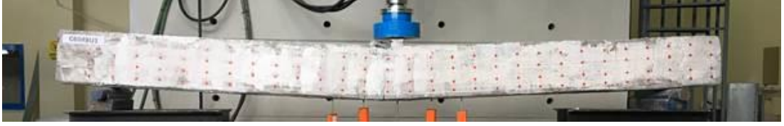
Şekil 3.4 Deney öncesi ve sonrası C6.0RBU1 kirişi görünümleri ((a)Yükleme başlamadan önce C6.0RBU1 kirişi ön yüzü, (b) Güç tükenmesine oluşumu sonrası C6.0RBU1 kirişi ön yüzü)
