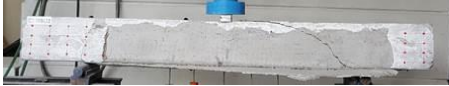
Şekil 3.6 Deney öncesi ve sonrası C3.5RBU2 kirişi görünümleri ((a)Yüklemeye başlamadan önce C3.5RBU2 kirişi ön yüzü, (b) Güç tükenmesine oluşumu sonrası C3.5RBU2 kirişi ön yüzü)
