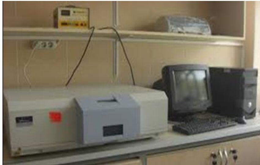
Şekil 4.13. Fotolüminesans ölçümleri için kullanılan cihazı
