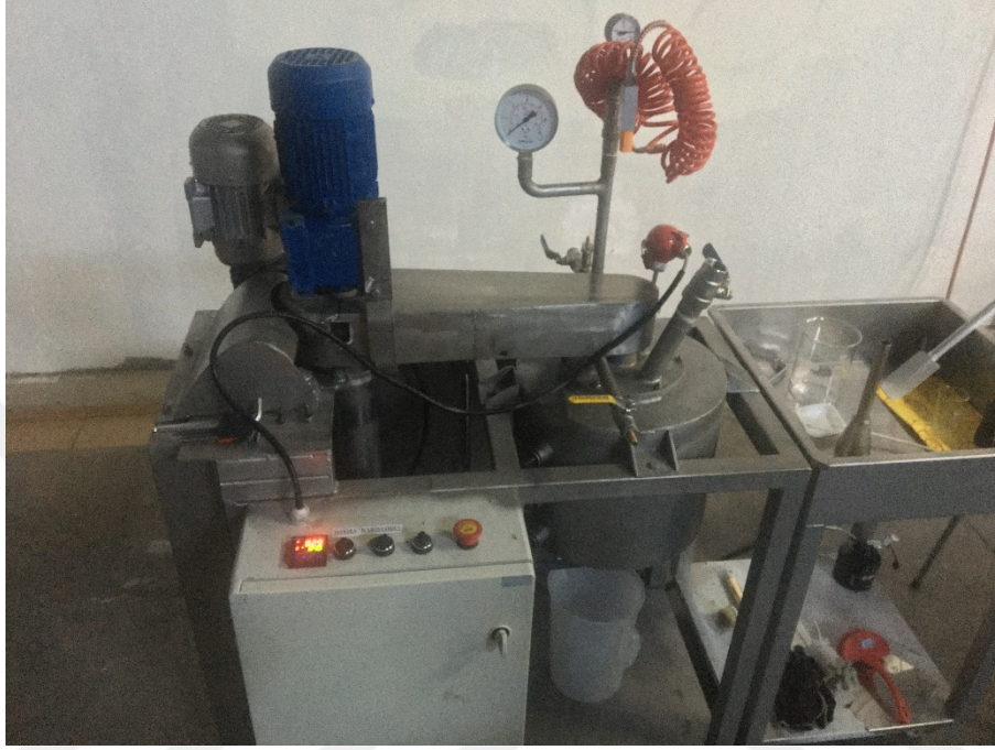
Şekil 3.3 Su kesici ve parlaticı deneme üretimlerinin yapıldığı mini reaktör
